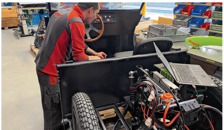
L'unité d'entraînement d'un Rapid «Uri» avec la batterie remplaçable (sous l'ordinateur portable) sur le châssis. Photo: Rapid
