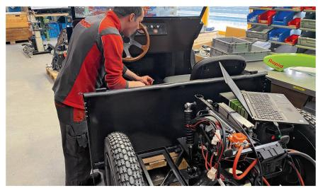
L'unité d'entraînement d'un Rapid «Uri» avec la batterie remplaçable (sous l'ordinateur portable) sur le châssis. Photo: Rapid
