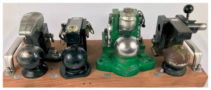
Quatre systèmes de verrouillage du système à boule 80 de différents constructeurs sont présentés sur cette photo. Photos: Walterscheid
