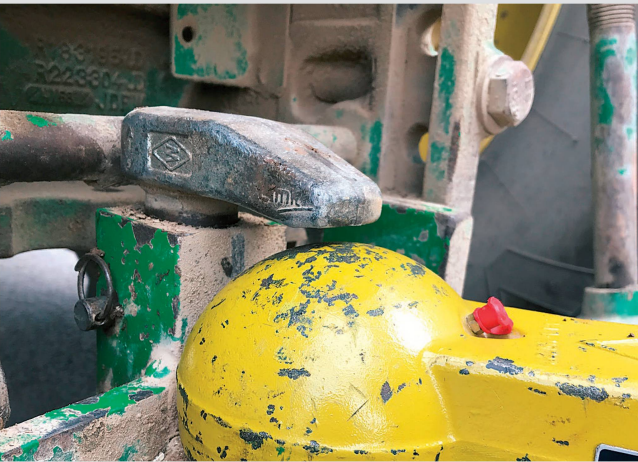
Mauvais réglage du levier de retenue: le «jeu» entre le levier de retenue et la calotte est beaucoup trop important!
