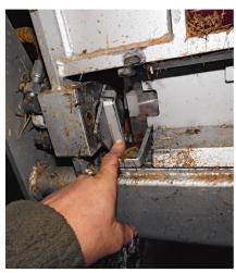
Ce couvercle automatique protège les raccords contre les grosses souillures.
