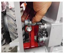
Le raccord rapide permet de connecter le système à deux distributeurs à double effet associés à une prise électrique 3 ou 7 pôles, ou à un retour libre. Les pièces d'usure normale sont standardisées. Les tuyaux hydrauliques doivent être prévus et installés par le monteur.
