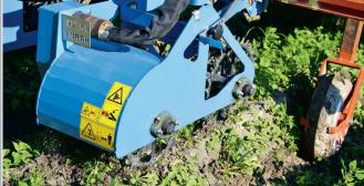
Connu encore sous la dénomination «Dulks Abrah Damm», l'outil de Roland Nold, est monté sur le châssis d'une bineuse. Les unités de binage peuvent être montées sur les châssis les plus courants.
