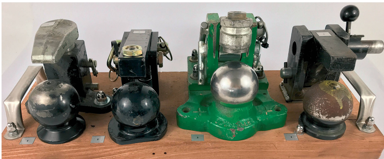
Quatre systèmes de verrouillage du système à boule 80 de différents constructeurs sont présentés sur cette photo. Photos: Walterscheid
