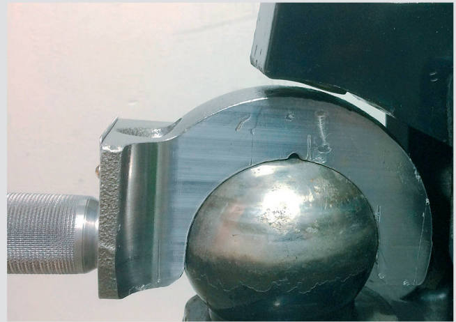
La calotte de contrôle Walterscheid permet de vérifier facilement le levier de retenue.
