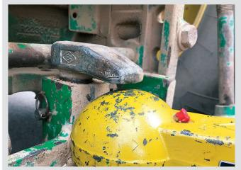
Mauvais réglage du levier de retenue: le «jeu» entre le levier de retenue et la calotte est beaucoup trop important!
