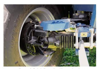
Les quatre disques de frein à disques humides ne nécessitent aucun entretien.
