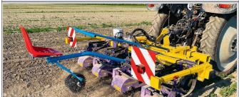
Cette bineuse «Feldklasse» traite simultanément quatre buttes. La largeur de travail maximale pour chaque sommet de butte est de 24 cm. Les bineuses peuvent être modulées pour traiter deux, trois, quatre, six ou huit buttes en même temps. Chaque unité pèse une cinquantaine de kilos. La vitesse de travail varie de 1,5 à 6 km/h selon la culture.
