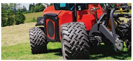
De grandes roues et quatre modes de direction: sur les roues avant, sur les quatre roues, marche en crabe ou manuelle. La compensation de glissement est livrée en option.
