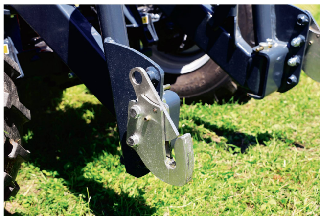
Il est possible de modifier les bras inférieurs du relevage avant de la catégorie 1 à la catégorie 2.
