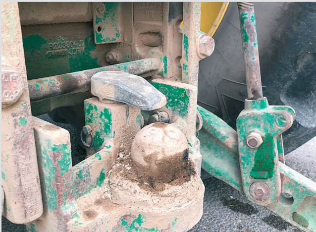
Cet état usé d'un attelage arrière de tracteur se rencontre trop fréquemment.
