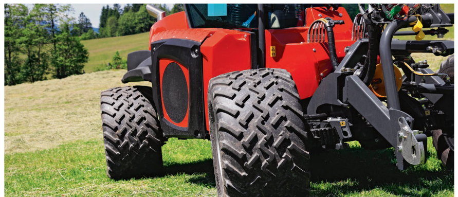
De grandes roues et quatre modes de direction: sur les roues avant, sur les quatre roues, marche en crabe ou manuelle. La compensation de glissement est livrée en option.
