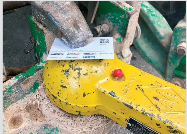
Réglage correct du levier de retenue: 0,5 mm équivaut à l'épaisseur d'une carte de visite.
