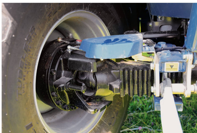
Les quatre disques de frein à disques humides ne nécessitent aucun entretien.
