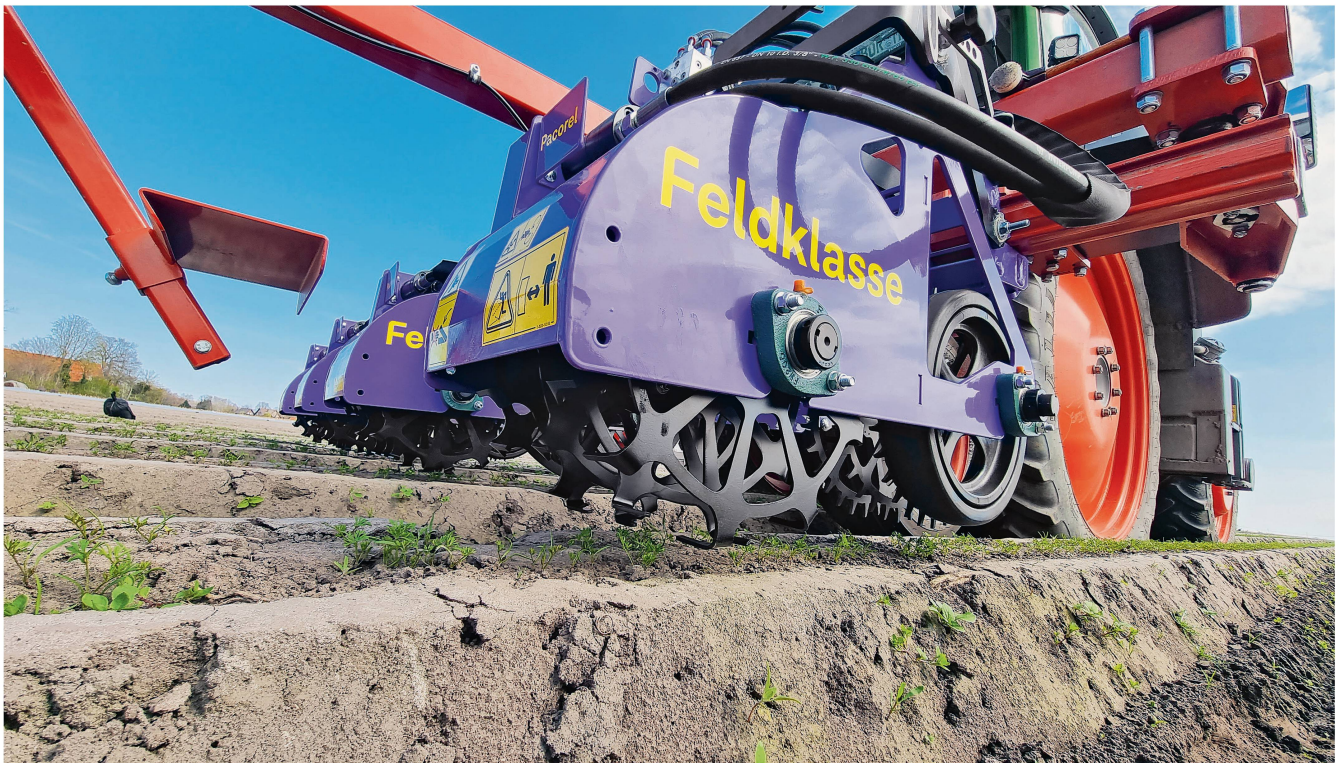
Unité de binage de la «Feldklasse»: on aperçoit ici les disques à créneaux (à l'avant de l'outil) avec la roue de jauge, suivis des socs rotatifs.
