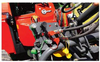
Le «Grip 4-70» est équipé de raccords hydrauliques plats à l'avant et à l'arrière. Hélas, ils sont disposés à l'opposé de la porte de la cabine.
