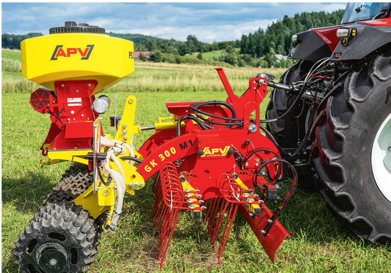
Cette combinaison compacte herse-étrille et semoir comporte deux rangées de dents. Photo: APV
