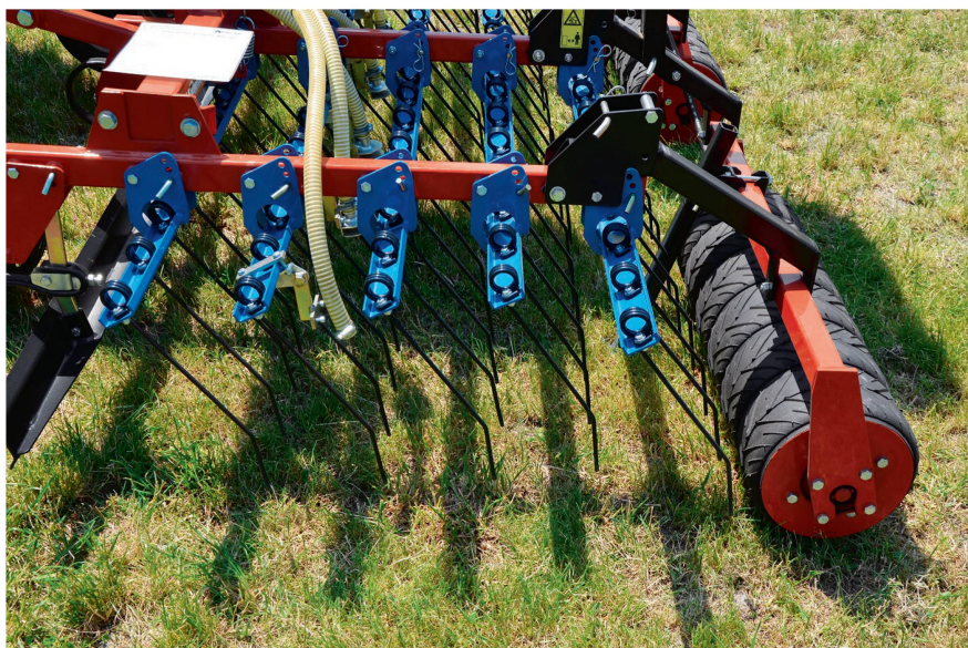
La combinaison de dents d'étrille, d'équipement de sursemis et d'éléments de rouleaux assure un bon contact de la semence avec le sol. Photo: Ruedi Hunger
