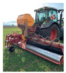
Les sursemis sont pratiqués à l'aide d'un semoir Vredo à semis directs avec un rouleau lisse, d'une largeur de travail de 6 mètres. Photo Idd
