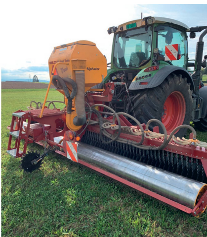
Les sursemis sont pratiqués à l'aide d'un semoir Vredo à semis directs avec un rouleau lisse, d'une largeur de travail de 6 mètres. Photo: Idd
