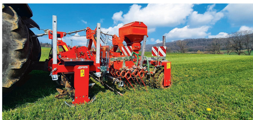
Les aérateurs de prairie éliminent les éléments compactés de la structure supérieure du sol.
