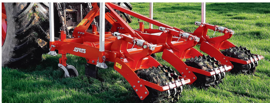
Avec un décompacteur, pas de demi-mesure : l'ameublissement a lieu en profondeur. Photo: Evers
