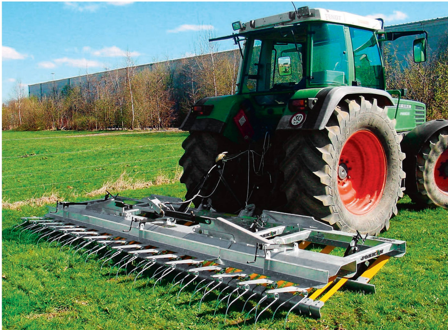
L'aérateur à lames, palettes et dents convient bien à l'entretien des pâtures. Photo: Joskin
