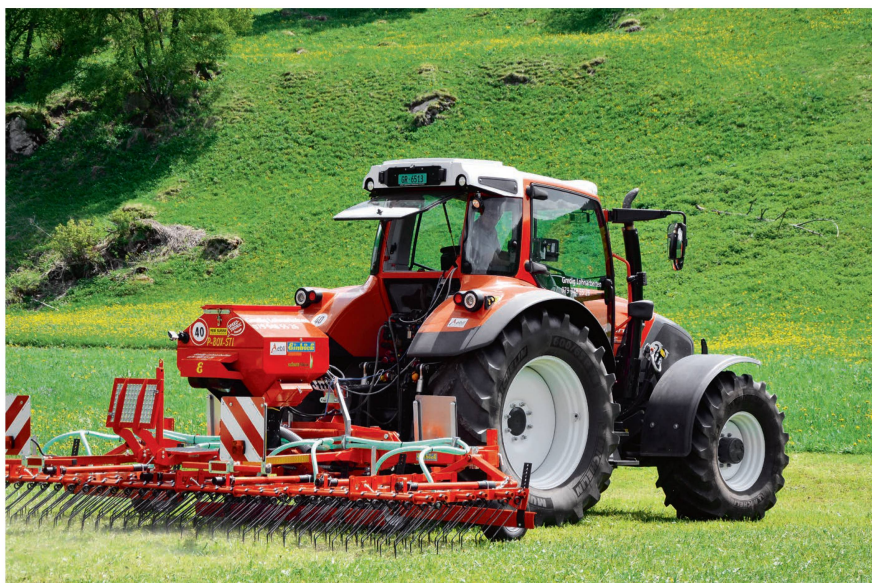
Les dents de la herse sont réparties sur plusieurs segments, ce qui permet une bonne adaptation au sol. Photo: Ruedi Hunger
