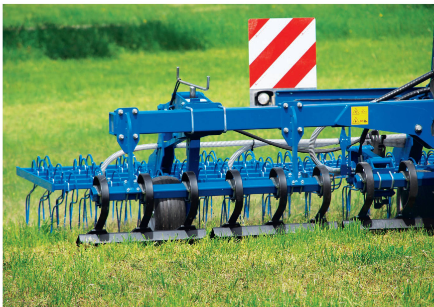
Un dispositif de nivellement à ressort composé de plusieurs segments est monté devant les dents de la herse. Photo: Köckerling
