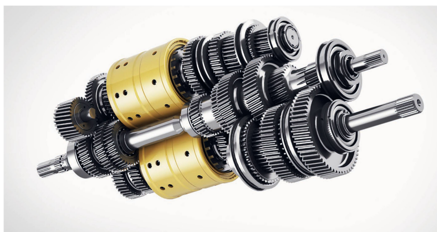
Figure 3.1: Transmission à 8 rapports commutables sous charge à double embrayage CNH. Deux embrayages multidisques suffisent pour les 8 rapports. Image: New Holland
