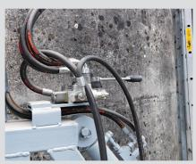
Les bras latéraux du pique-bottes arrière se manœuvrent hydrauliquement.
