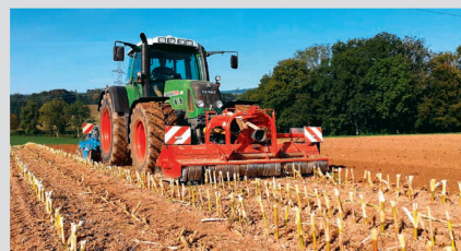
Le «Système de broyage-décapage-semis Villiger» à l'ouvrage pour combattre la pyrale.
