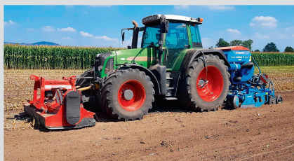
Le «Système de broyage-décapage-semis Villiger» à l'ouvrage pour combattre la pyrale.
