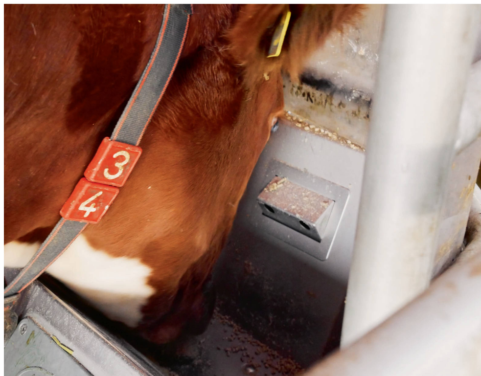
Deux buses pilotées par des soupapes sont intégrées dans l'auge du robot de traite.
