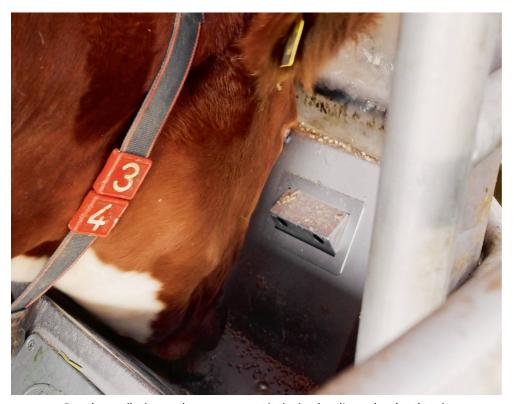
Deux buses pilotées par des soupapes sont intégrées dans l'auge du robot de traite. Photos Roman Engeler
