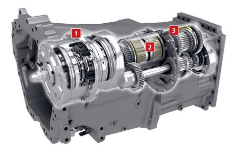
Figure 2: Transmission Claas «Hexashift» avec, à gauche (1), les trois trains épicycloïdaux («planétaires») pour les 6 rapports commutables sous charge, au centre (2) le dispositif inverseur et, à droite (3), les gammes de vitesses. Illustration: Claas
