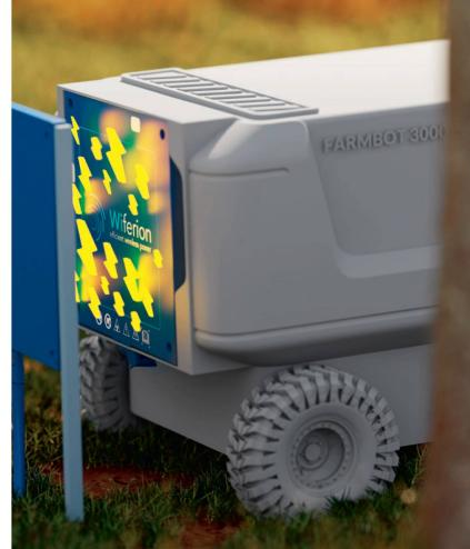
ment fiable en énergie. Le système fonctionne en plug-and-play et peut actuellement charger avec une puissance de 3 kW. Le chargeur peut alimenter en courant tout type de batteries communes, ceci quel que soit le type de chimie employée dans les cellules. Afin que tout le potentiel d'approvisionnement puisse être exploité, les experts en énergie de «Wiferion» recommandent l'utilisation de batteries Li-ion.
