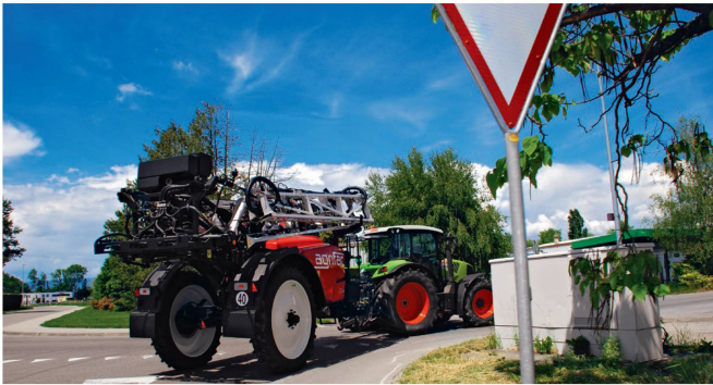
Les pulvérisateurs trainés appartiennent à la catégorie «remorques de transports». Ils possèdent une citerne pour le transport de liquide.
