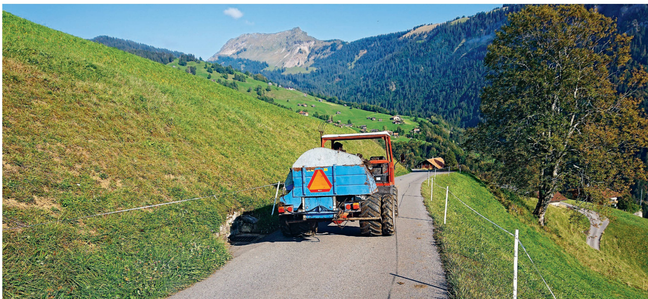
Les transporteurs et les faucheuses à deux essieux appartiennent à la catégorie de véhicules agricoles «chariots à moteur» et sont limités à 30 km/h. Photos: Heinz Röthlisberger
