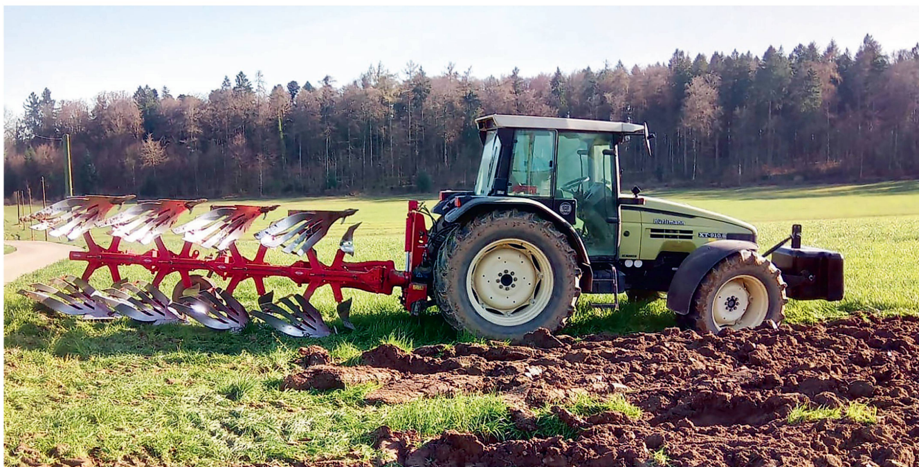
A la charrue 4-socs, le Hürlimann «XT 910.6» avec contrepoids avant en lieu et place du chargeur frontal. Photo: Beat Adam
