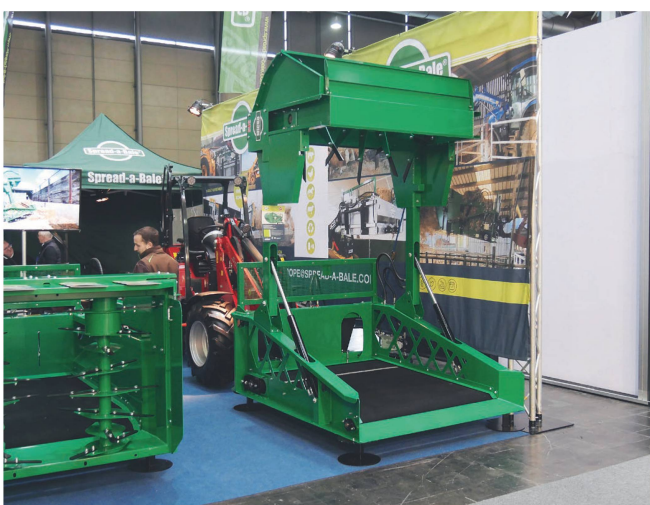
La dérouleuse de balles «Micro» de Spread-a-Bale pèse 695 kilos. Selon le fabricant, elle peut être entraînée par un chargeur de ferme affichant au moins 2,7 tonnes de poids propre et 50 chevaux.
