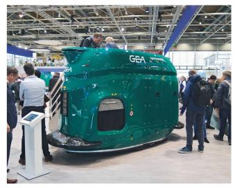
Le robot d'affouragement «DairyFeed F4500» de GEA est entraîné par un moteur électrique. Il est équipé de capteurs de navigation lui permettant de suivre la route idéale pour distribuer la ration.
