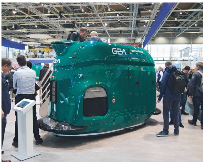
Le robot d'affouragement «DairyFeed F4500» de GEA est entraîné par un moteur électrique. Il est équipé de capteurs de navigation lui permettant de suivre la route idéale pour distribuer la ration.
