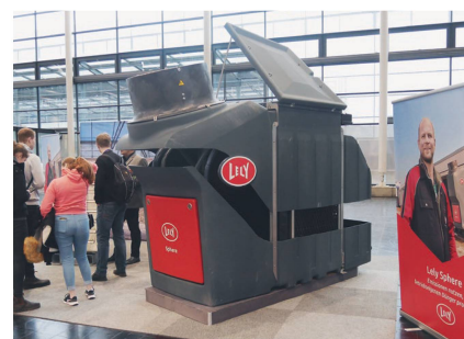
A l'étable, Lely «Sphere» est un système de traitement du lisier qui sépare le purin et l'urine et transforme les émissions d'azote en engrais.
