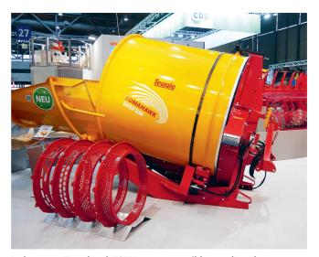
Le broyeur «Tomahawk 505M» est compatible avec l'attelage trois-points du fabricant Teagle (GB). L'allongement du tambour facilite le chargement. Une puissance de 120 chevaux est requise.
