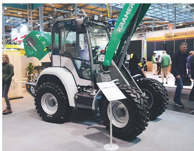
Le Kramer «KL25.5e» à batterie au lithium-ion de 96 volts remplacera la première génération de chargeurs électriques. Selon Kramer, la charge maximale est de 1750 kilos et son autonomie de 4 heures.
