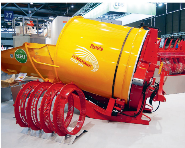
Le broyeur «Tomahawk 505M» est compatible avec l'attelage trois-points du fabricant Teagle (GB). L'allongement du tambour facilite le chargement. Une puissance de 120 chevaux est requise.
