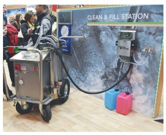
La «Clean & Fill Station» de Förster-Technik nettoie automatiquement les chariots à lait, les remplit avec de l'eau qu'elle chauffe de manière à ce qu'il n'y ait plus que de la poudre de lait à ajouter.
