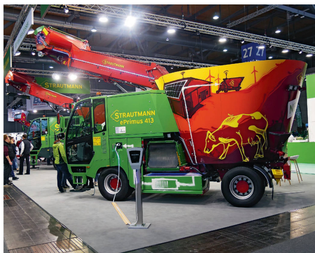
La commercialisation de la mélangeuse automotrice «EPrimus 413» de Strautmann est prévue pour 2024. Quatre moteurs électriques entraînent la fraise, la mélangeuse, les fonctions et la transmission.
