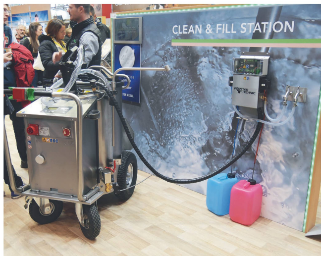
La «Clean & Fill Station» de Förster-Technik nettoie automatiquement les chariots à lait, les remplit avec de l'eau qu'elle chauffe de manière à ce qu'il n'y ait plus que de la poudre de lait à ajouter.
