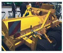
terre. Le défanage mécanique permet de contrôler la maturation des plantes dans les délais impartis et donc la fermeté de la peau des tubercules ainsi que d'autres aspects qualitatifs. De plus, les buttes fissurées consécutivement à une sécheresse sont remises en forme.
