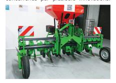
Ses roues de jauge sont réglables hydrauliquement et sont placées à l'avant. La largeur de la butte peut être choisie librement en fonction de la voie du tracteur. Les tiges de binage et les socs butteurs sont réglables en continu. La charrue intègre une unité de montage rapide pour les semoirs courants (par ex. Krummenacher). Les socs à disgues sont montés sur des paliers en caoutchouc et un rouleau de rappui est disponible en option.
