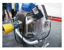
de machines de location, le louer à leurs clients et l'utiliser parallèlement comme banc d'essai de puissance pour des tracteurs jusqu'à 400 chevaux.
