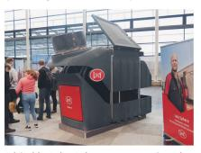
A l'étable, Lely «Sphere» est un système de traitement du lisier qui sépare le purin et l'urine et transforme les émissions d'azote en engrais.
