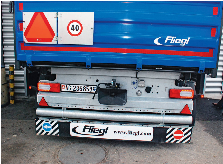
Une remorque industrielle à 40 km/h doit toujours être immatriculée et équipée d'une plaque blanche.
