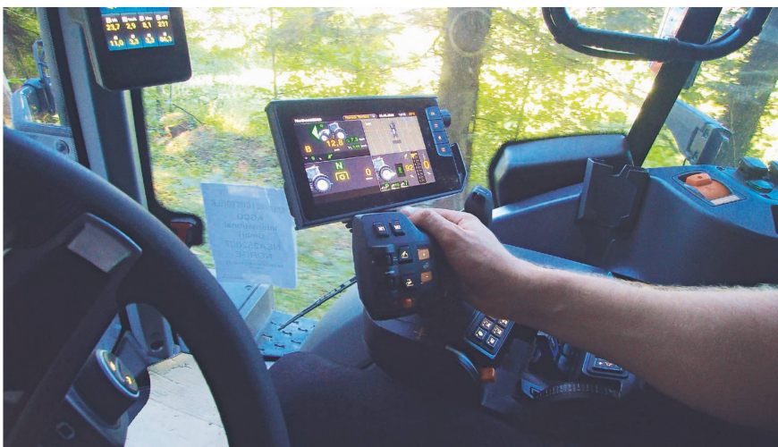
Le concept de commandes «SmartTouch» comprend l'écran standard avec le levier de conduite sur l'accoudoir. Un écran additionnel avec les indications sur les états de fonctionnement est installé sur le montant avant droit.
