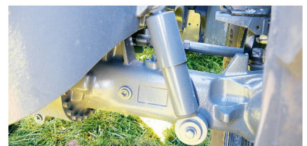
L'essieu avant est doté d'une suspension pneumatique.
