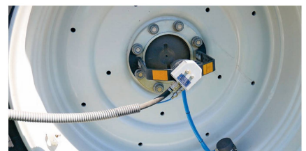
Un système de contrôle de la pression des pneus est disponible en option à l'usine. Valtra se fournit auprès de PTG.
