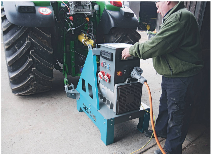
Avec une génératrice à prise de force, il est possible, en cas de panne de courant, de fournir suffisamment d'électricité pour alimenter une exploitation composée d'un bâtiment d'habitation et d'une étable. Photos: Martin Abderhalden et Roman Engeler
