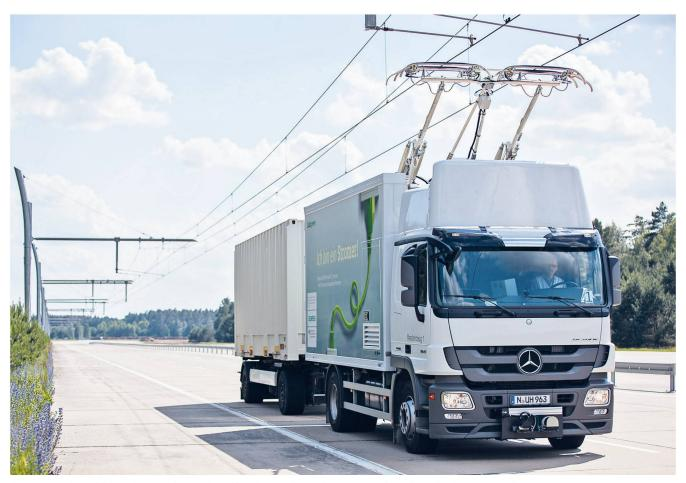
Nous avons du mal à imaginer que les camions électriques alimentés par un système de caténaires entrent dans la norme. Photo: Siemens
