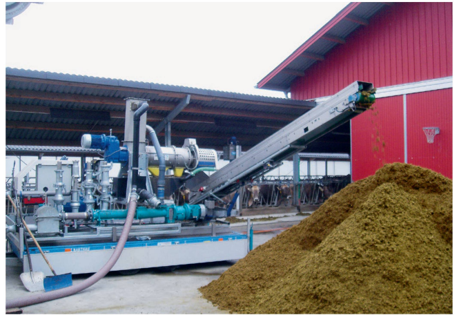
Cette installation mobile sert à séparer les phases liquide et solide des engrais de ferme. Photo: Jean-Louis Hersener
