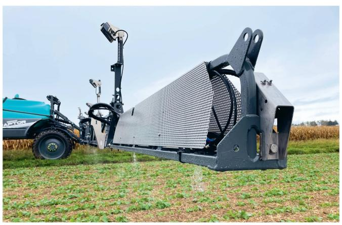
Une rampe équipée du dispositif «Sniper» traite cette parcelle de colza de façon ultralocalisée, en suivant les consignes du modèle choisi par l'agriculteur. Photos: M. Schubnel
