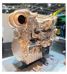
Le moteur JD18X est doté d'un système de dépollution dépourvu de SCR (réduction catalytique sélective) et ne requiert donc pas d'AdBlue.
