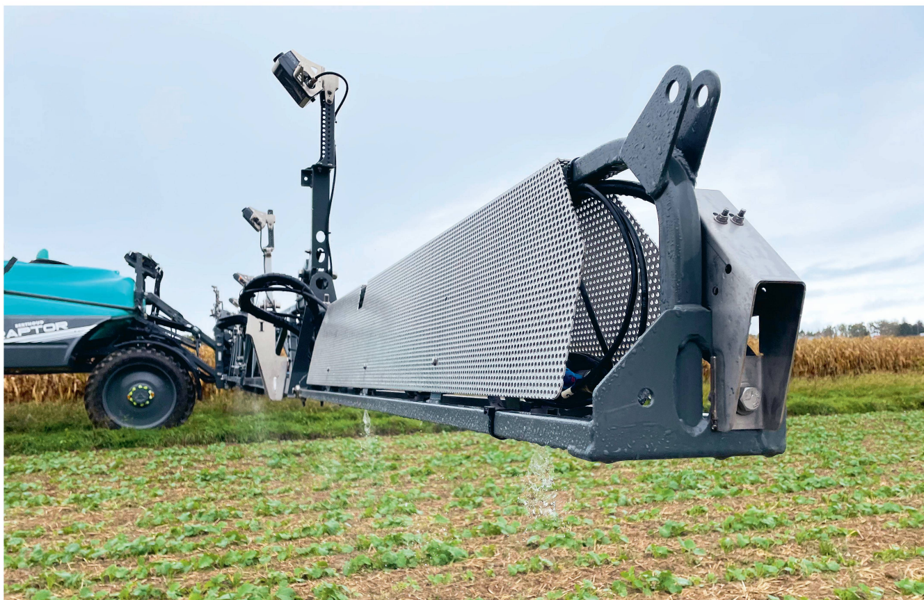
Une rampe équipée du dispositif «Sniper» traite cette parcelle de colza de façon ultralocalisée, en suivant les consignes du modèle choisi par l'agriculteur. Photos: M. Schubnel
