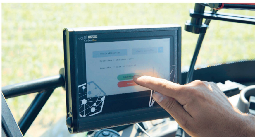
Depuis le boîtier de contrôle en cabine, l'opérateur visualise par exemple la surface totale scannée et la surface effectivement traitée. Photo: Berthoud
