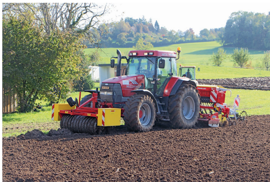
Semis combiné au semoir mécanique porté Pöttinger «Vitasem 302 A», complété par un passage préalable au rouleau packer frontal. Photo: Romy Widmer
