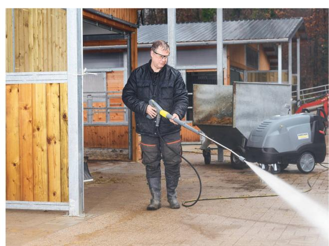
**Le nettoyage humide peut être effectué au nettoyeur haute pression à eau froide ou chaude.**
