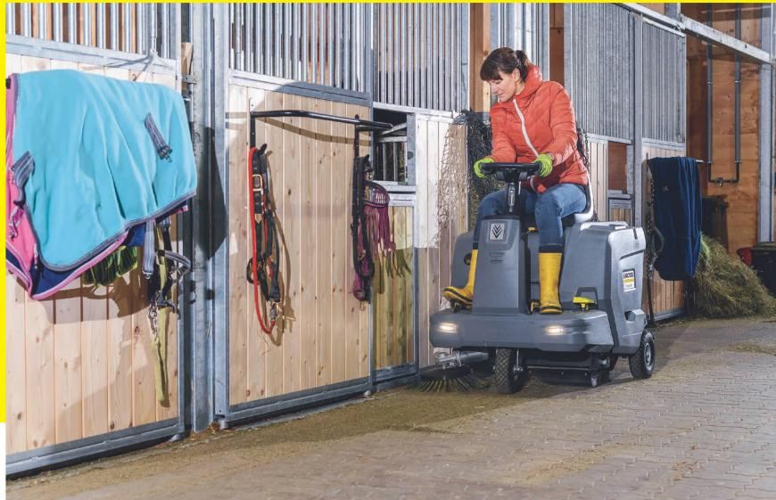
Les surfaces de grande taille comme les allées de l'écurie se nettoient bien plus rapidement et sans effort physique avec une machine autoportée. La machine doit de préférence être munie d'une brosse latérale pour traiter en même temps les bordures.
