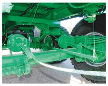
Le train tandem renforcé avec suspension à trois lames paraboliques et son essieu suiveur à verrouillage hydraulique.
