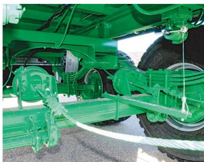
Le train tandem renforcé avec suspension à trois lames paraboliques et son essieu suiveur à verrouillage hydraulique.
