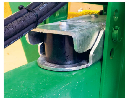
La suspension du timon dotée de tampons en caoutchouc est disponible de série sur la remorque «Agripush».
