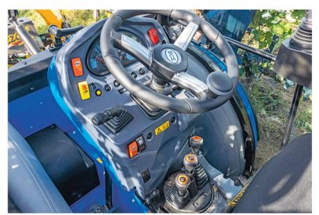
Les leviers de changement de rapports sont disposés au centre, au-dessus du tunnel de transmission et possèdent un bouton pour commander l'embrayage.
