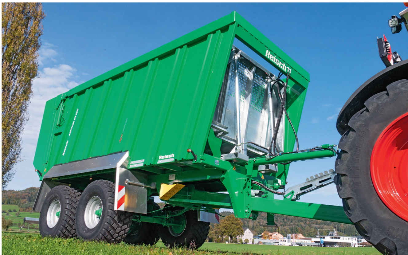
La marque Reisch souhaite rebattre les cartes sur le marché des remorques à fond poussant avec sa gamme de remorques «Agripush». On voit sur la photo la version «Swiss Edition» du modèle «RTAS-180.575 Eco». Photos: Roman Engeler
