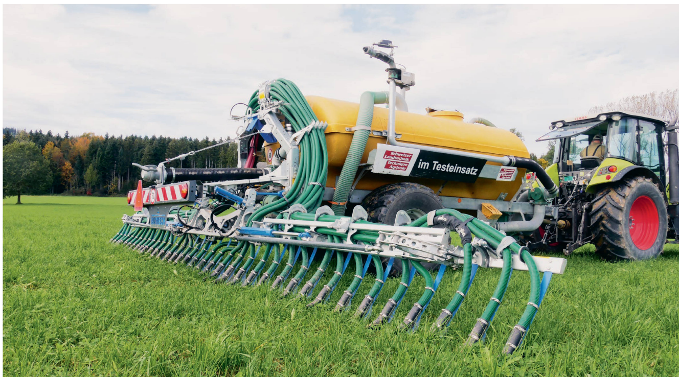
La rampe à patins «UP» de Bomech n'est pas donnée, en revanche toute citerne à lisier peut en être équipée.
