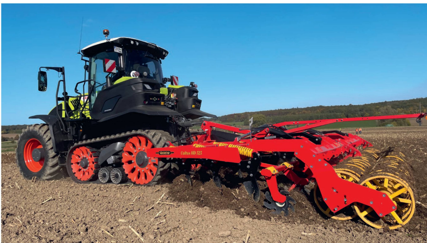
Le déchaumeur à dents inédit «Cultus HD» (ici le modèle «525») dispose de sécurités non-stop mécaniques, dont le seuil de déclenchement peut atteindre 680 kg.
