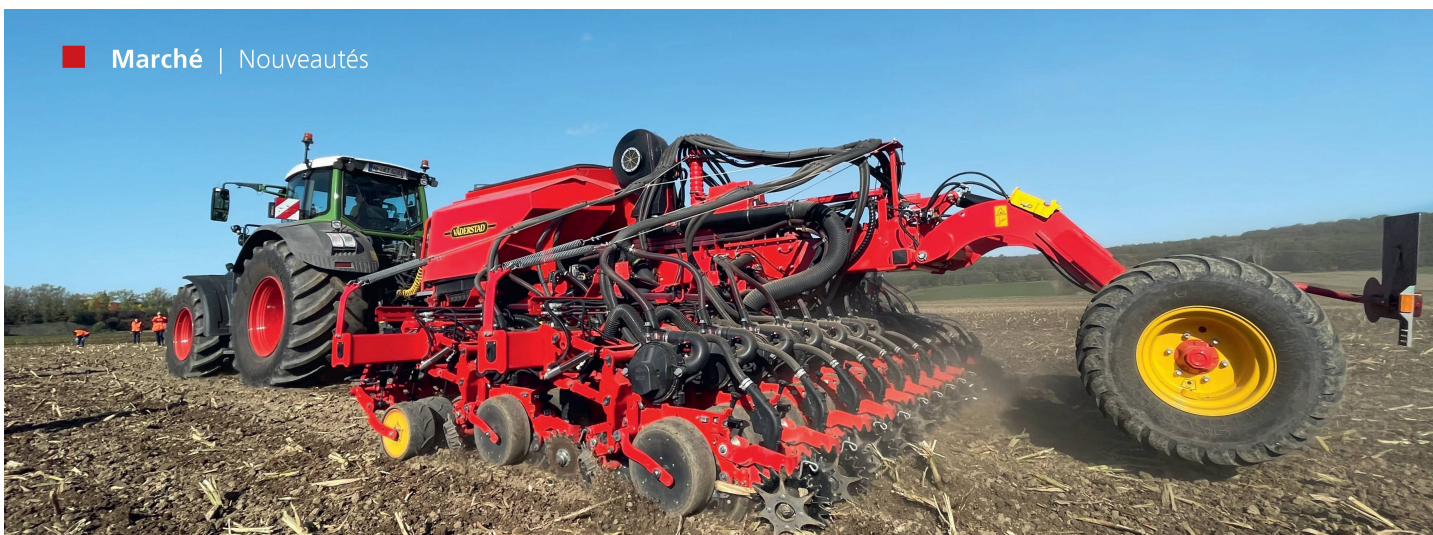
Capable de semer la plupart des cultures, le semoir «Proceed» est doté de roues indépendantes rattachant le lit de semence de manière à créer des conditions de levée homogènes. Photos: Matthieu Schubnel
