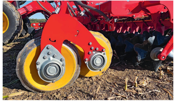
Chez Väderstad, chaque roulement adopte de série un anneau amortisseur en caoutchouc prolongeant la durée de vie de l'outil.
