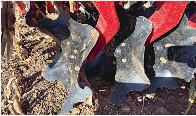
Le nouveau disque «CrossCutter Disc Aggressive» s'adapterait mieux aux terres lourdes ou si la capacité de pénétration pose problème.
