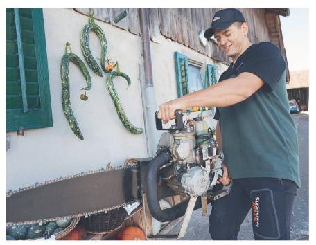
Oliver Reinhard montre sa tronconneuse «Hot Saw», avec son moteur de moto KTM de 390 cm³ développant 70 chevaux et sa chaîne à dents hautes. Photos: Dominik Senn
