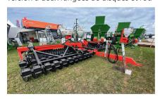
leau Cambridge. Il peut également embarquer un semoir à petites graines optionnel. Cet outil traîné se décline en largeurs fixe de 3 m ou repliable de 6,20 m. La puissance minimale requise oscille entre 90 et 140 ch selon le modèle.
