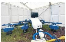
une faneuse et un andaineur. Il compte quatre rotors de 1,5 m de diamètre entraînés hydrauliquement grâce à une centrale hydraulique embarquée à deux pompes et réservoir de 300 litres d'huile. Sa vente est prévue à partir de 2024.
