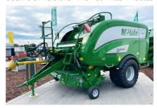
adoptent le nouveau pick-up «Profi-Flo» à 5 rangées de dents (6 sans cames en option). La fonction inédite d'alimentation adaptative ajuste le volume de fourrage. Elles comptent également une double pompe à graisse et huile, un frein de rouleau de liage redimensionné ou encore, à l'arrière, un panneau de commandes multiples (modèles «Pro» et «Plus»). Cette dernière se distingue par sa trappe de débourrage automatique et ses larges pneumatigues optionnels.
