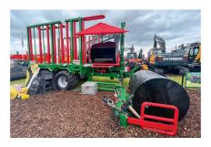
ger les balles sur deux hauteurs puis de les transférer de façon semi-automatique. Pilotée par joystick, elle embarque ainsi jusqu'à 16 unités. Grâce à son bras latéral hydraulique et à sa pince de préhension des balles, elle ne requiert qu'un seul tracteur et un opérateur. Le déchargement a lieu en deux phases par basculement à la verticale.
