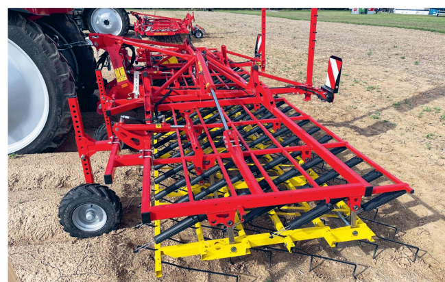
A gauche, le décompacteur Evers «breton» dans sa version à six dents. En haut à droite, le défaneur mécanique MSR «Crown Crusher» peut être converti en outil de désherbage. En bas à droite, les «VarioStriegl» légères s'adaptent aux cultures en buttes.
