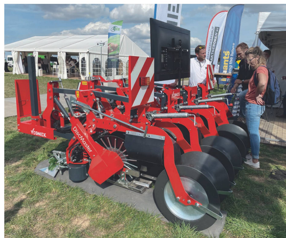
A gauche, le combiné de plantation AVR «Ceres 450» avec herse rotative et à droite le défaneur mécanique Vegniek «DiscMaster».
