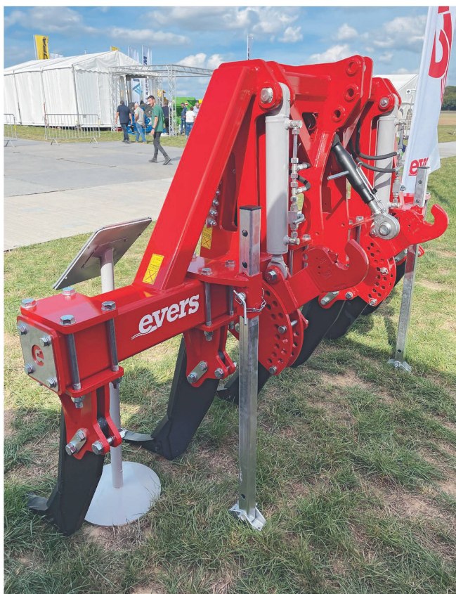
A gauche, le décompacteur Evers «breton» dans sa version à six dents. En haut à droite, le défaneur mécanique MSR «Crown Crusher» peut être converti en outil de désherbage. En bas à droite, les «VarioStriegl» légères s'adaptent aux cultures en buttes.
