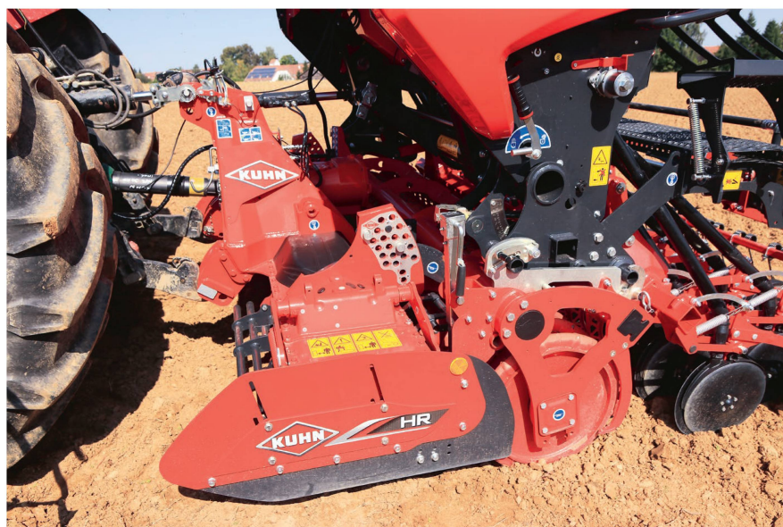
Le «Sitera 3030e» est monté par un attelage rapide sur le rouleau. La herse rotative a fourni de bonnes prestations.
