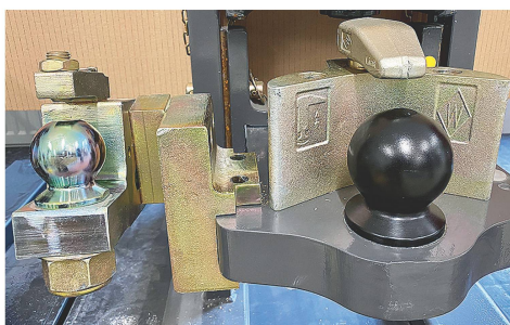
Ces points de fixation peuvent être intégrés sur différents supports de boules «K80».
