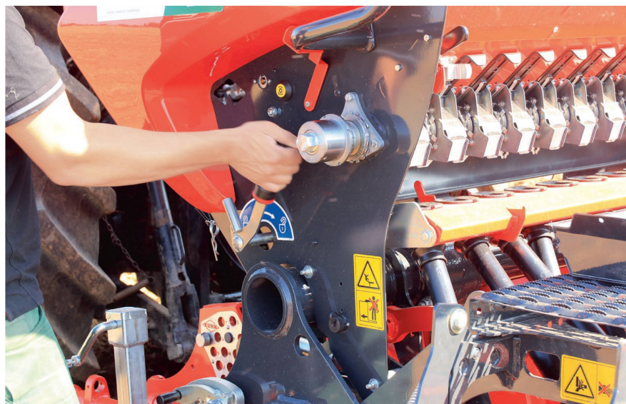
La grande vis sur le côté gauche sert à régler la contenance des cannelures des roues des distributeurs.
