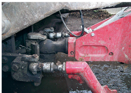
Exemple d'un attelage à direction forcée.
