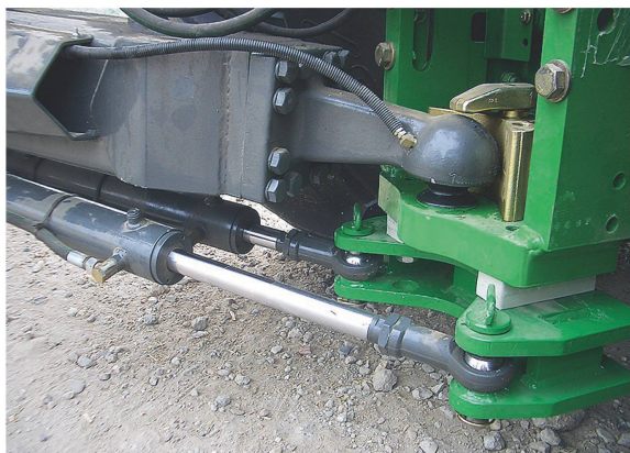
Exemple de dispositif d'attelage non conforme aux normes. Dans ce cas, une autorisation du constructeur est nécessaire.
