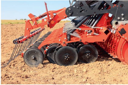
Le système de socs «Seedflex» a fourni un très bon travail. Seul le réglage de la pression se révèle un peu fastidieux.
