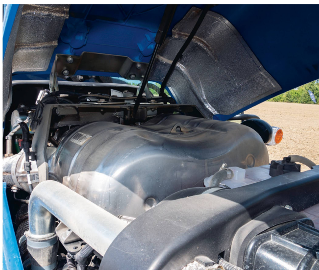
Le moteur est conforme à la norme anti-pollution de niveau 5 grâce au système compact et sans entretien «Hi-eSCR2».
