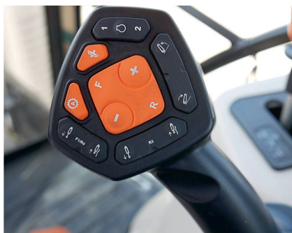
Le levier de vitesses multifonction gère notamment l'inverseur sous charge
