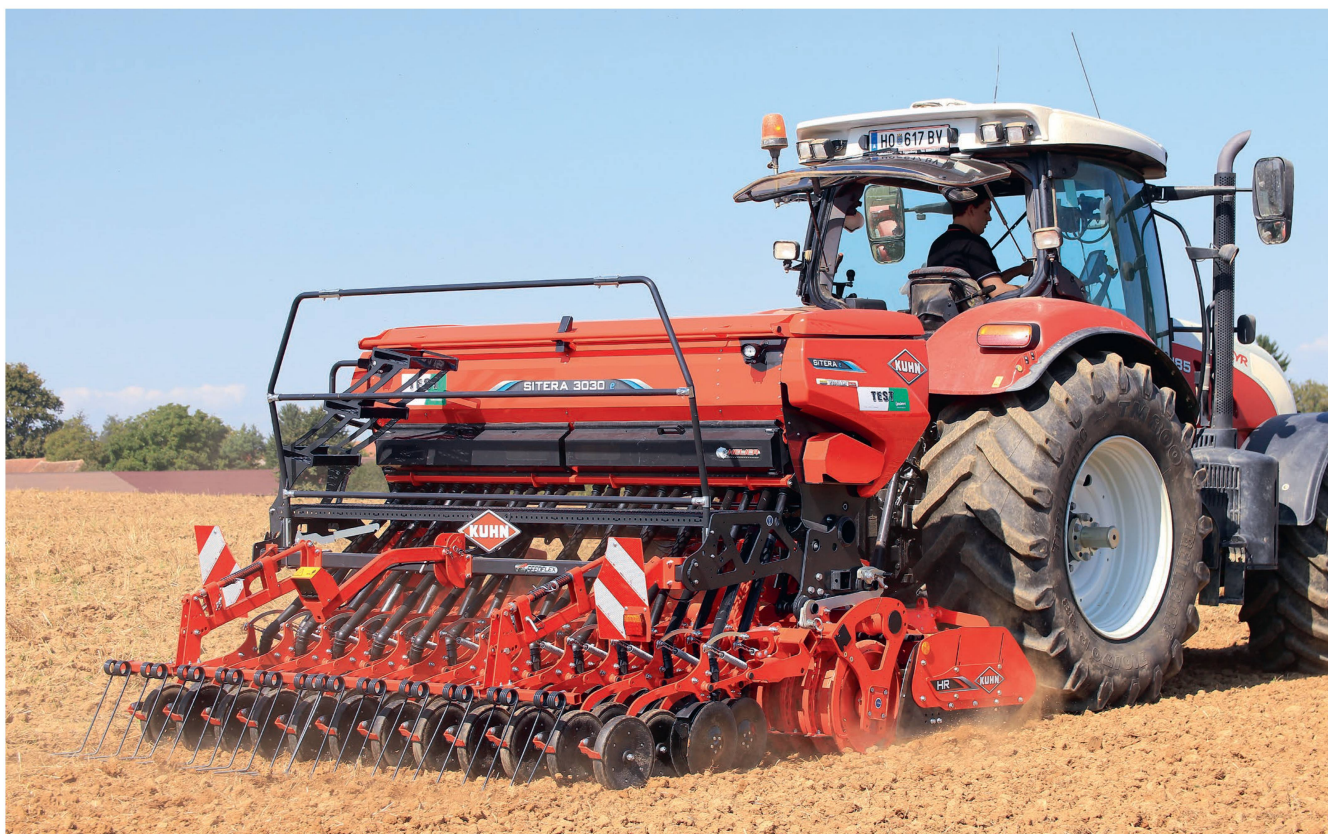
Le modèle à distributeurs électriques «Sitera 3030e» est le vaisseau amiral des semoirs mécaniques Kuhn. Photos: Lukas Weninger
