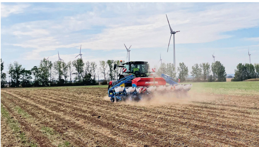
Avec le nouveau système de guidage «AutoPath», la semence est placée précisément au-dessus de la bande de lisier, y compris lors de passages irréguliers et dans les courbes.
