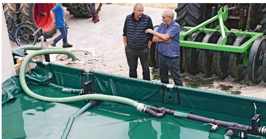
Les tuyaux se rejoignent au pied du système et sont raccordés au réservoir d'eau et au dispositif de remplissage (un système de trop-plein avec sonde intégrée).
