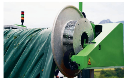
Le système de transmission mécanique de l'appareil d'enroulement au dévidoir.
