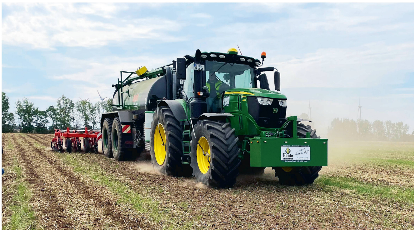
L'analyseur «HarvestLab 3000» sur cette tonne à lisier permet de connaître et d'ajuster précisément les apports de nutriments. Photos: M Schubnel
