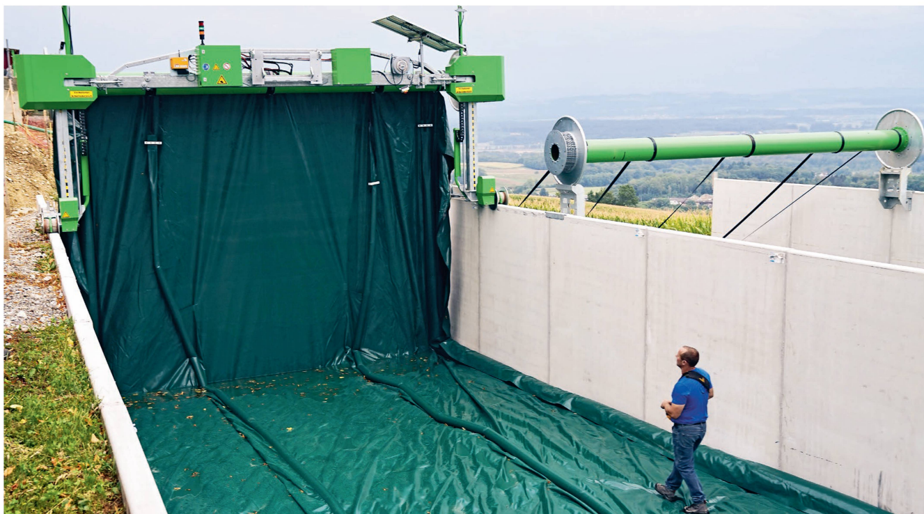
Le système de couverture panneaux solaires d'alimentation, moteurs électriques et dévidoir roule en avant, sur le sommet du mur, l'eau excédentaire refluant au fur et à mesure. On aperçoit à droite le dévidoir sans enrouleur du deuxième silo-couloir. Photos: Dominik Senn
