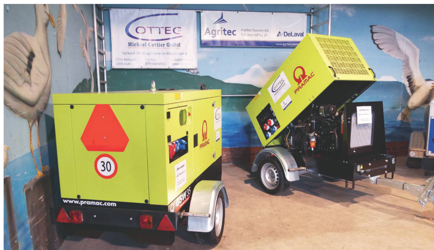
Un îlotage avec un groupe électrogène de secours peut être constitué dans la plupart des exploitations. La condition est d'opérer une séparation galvanique entre le réseau et l'îlot.
