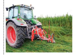
sitif d'élévation à l'avant permet de sélectionner la longueur des tiges et de la modifier. Les barres de coupe Bidux avec ses couteaux dentelés Carbodux à écartements inégaux 70/84 mm sont garants d'une coupe nette. Ces faucheuses à double lame sont animées hydrauliquement et requièrent une puissance de l'ordre de 50 ch/37 kW.
