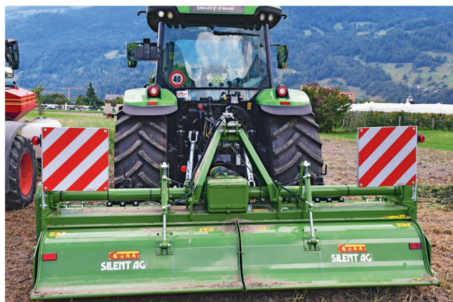
La fraise rotative de Celli équipée de lames coudées hache les plantes et les recouvre de terre avec facilité.
