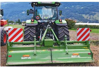
La fraise rotative de Celli équipée de lames coudées hache les plantes et les recouvre de terre avec facilité.
