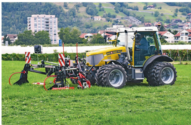
Le Rigitrac «SKH 75» avec barre de coupe à double lames de BB Umwelttechnik a fait l'objet d'une démonstration.
