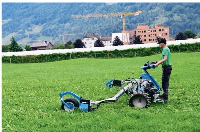
L'une des motofaucheuses présentées est une Brielmaier munie d'une barre de coupe à double lame «Bidux».
