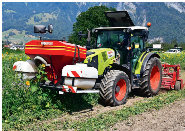
Le «Geohobel» de Flurin Frigg, de Pratval (GR), enfouit des engrais verts denses en surface.
