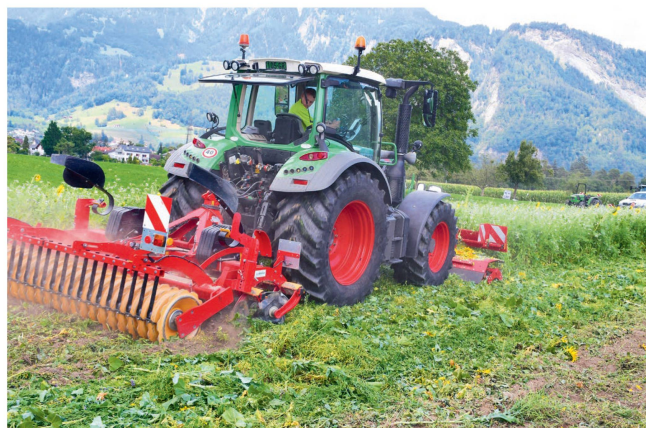
Le rouleau couteaux Horsch effectue le travail préalable à celui du déchaumeur Väderstad à l'arrière, doté de disques «CrossCutter».
