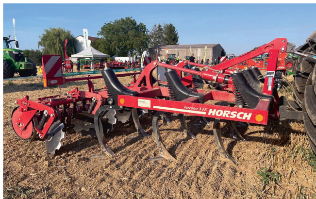
Horsch Terrano 3 FX porté: cet outil universel peu tirant de 3 m de largeur à trois rangées de dents et une rangée de disques crénelés est capable de travailler à une profondeur de 5 à 30 cm. Il adopte ici un rouleau arrière de type RollFlex. Il peut désormais être équipé d'ailerons de scalpage TerraCut pour un travail du sol superficiel.
