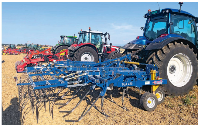
Treffler TGA 430: le nouveau scalpeur de précision porté travaillant très superficiellement sur une largeur de 4,30 m intègre trois rangées de dents se chevauchant sur 8 cm, associées à des dents de nivellement et à une herse peigne. Deux roues tandem contrôlent la profondeur de travail. La puissance requise n'excède pas 120 ch.
