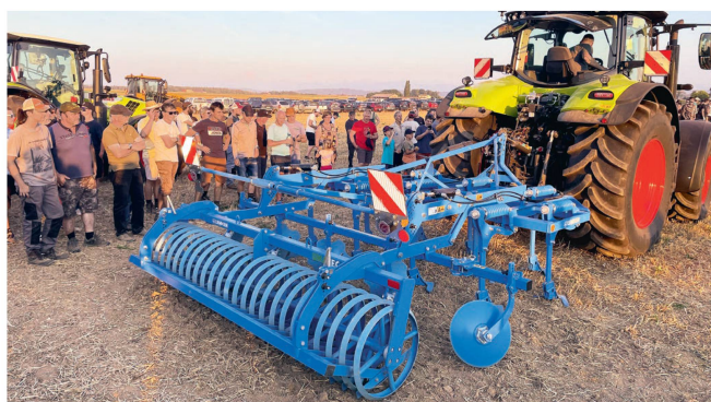
Lemken Karat 9: le déchaumeur porté éprouvé du constructeur allemand se caractérise par son grand dégagement entre ses trois rangées de dents, entre ses dents et sous bâti, ainsi compatible avec la présence de résidus culturaux. À l'arrière, son rouleau sillonneur maximise le contact sol-graine pour favoriser la levée de la culture implantée.
