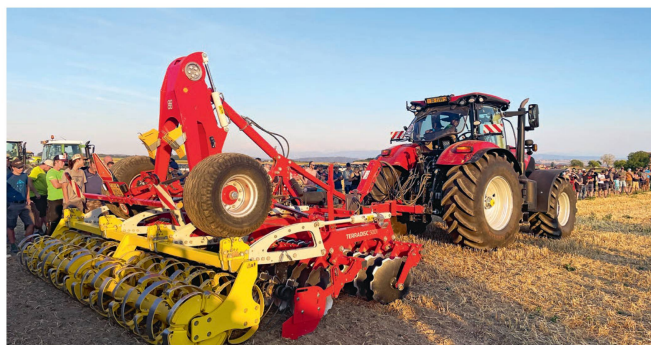
Pöttinger Terradisc 5001 T: cet imposant déchaumeur semi-porté présente deux rangées de disques crénelés, une herse peigne et un rouleau tandem Cornoroll. Il travaille sur 5 mètres de largeur et pèse 6 tonnes. Pöttinger a imaginé un repliage avancé du train routier reportant un maximum de poids sur la machine.
