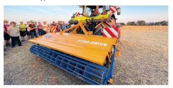
Bomford Turner Dyna-Drive: cette fraise rotative portée autoanimée de 3 m de large dispose de deux rotors à dents. Le 1er rotor bêche la terre et la projette sur le 2e rotor. L'allure de travail préconisée est de 8 à 12 km/h pour un débit de chantier de 3,5 à 4 ha/h. Cette machine polyvalente exige une puissance de traction de 130 à 140 ch.
