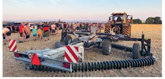
Fliegl KSE 680: la herse à disques sur chaînes semi-portée dispose de quatre trains de disques déchaumeurs, assemblés en losange. Elle travaille sur 4 à 10 cm de profondeur à l'allure de 12 à 18 km/h. Des vérins sont prévus pour régler l'angle d'attaque et ajuster la tension des chaînes. Sa largeur de travail atteint 6,80 m.
