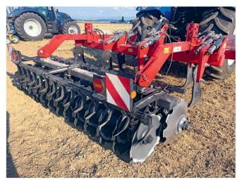
Grégoire Besson Helios Duo 60: ce décompacteur porté de 3 m de largeur présente deux rangées de dents courbes et une dent centrale droite. Il aère le terrain sans le déstructurer. L'appareil présenté dispose de sécurités non-stop hydrauliques à seuil de déclenchement réglable en cabine et, à l'arrière, deux rangées de disques crénelés de 580 mm de diamètre. Il peut travailler à une profondeur de 5 à 8 cm en-dessous de la semelle de labour, soit 30-35 cm minimum.
