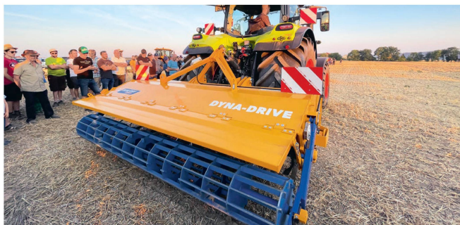
Bomford Turner Dyna-Drive: cette fraise rotative portée autoanimée de 3 m de large dispose de deux rotors à dents. Le 1 er rotor bêche la terre et la projette sur le 2 e rotor. L'allure de travail préconisée est de 8 à 12 km/h pour un débit de chantier de 3,5 à 4 ha/h. Cette machine polyvalente exige une puissance de traction de 130 à 140 ch.
