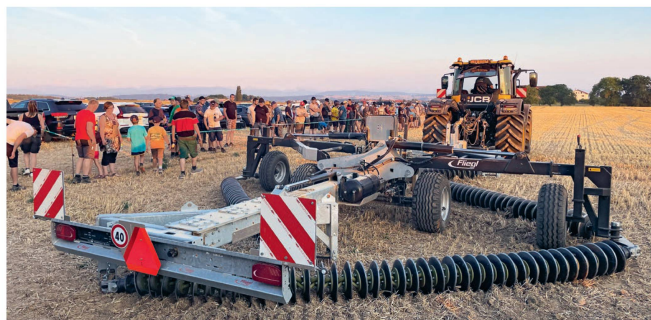
Fliegl KSE 680: la herse à disques sur chaînes semi-portée dispose de quatre trains de disques déchaumeurs, assemblés en losange. Elle travaille sur 4 à 10 cm de profondeur à l'allure de 12 à 18 km/h. Des vérins sont prévus pour régler l'angle d'attaque et ajuster la tension des chaînes. Sa largeur de travail atteint 6,80 m.
