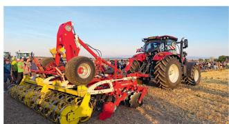
Pöttinger Terradisc 5001 T: cet imposant déchaumeur semi-porté présente deux rangées de disques crénelés, une herse peigne et un rouleau tandem Cornoroll. Il travaille sur 5 mètres de largeur et pèse 6 tonnes. Pöttinger a imaginé un repliage avancé du train routier reportant un maximum de poids sur la machine.
