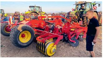
Väderstad Carrier XL 425: le déchaumeur à disques traîné est doté à l'avant d'un rouleau couteau réduisant les résidus. Ses disques de 450 à 600 mm de diamètre de type classiques ou spéciaux, comme ici avec des disques gaufrés CrossCutter, travaillent de façon superficielle, à une profondeur de 2 à 3 cm. Le rouleau silloneur arrière brise les résidus et rappuie le terrain.
