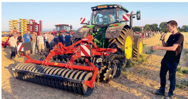
Kuhn Optimer XL 300: avec ses deux rangées de disques de 620 mm, sa herse peigne et son rouleau lourd T-Liner, ce déchaumeur porté de 3 m de largeur travaille sur 5 à 25 cm de profondeur. Il présente un grand dégagement. Requérant une puissance de 140 à 160 ch, il évolue à l'allure de 7 à 15 km/h.
