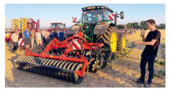
Kuhn Optimer XL 300: avec ses deux rangées de disques de 620 mm, sa herse peigne et son rouleau lourd T-Liner, ce déchaumeur porté de 3 m de largeur travaille sur 5 à 25 cm de profondeur. Il présente un grand dégagement. Requérant une puissance de 140 à 160 ch, il évolue à l'allure de 7 à 15 km/h.
