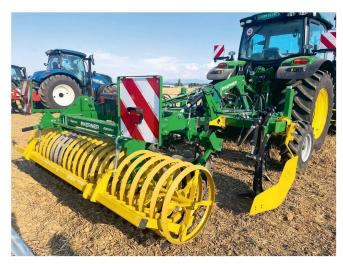
Kerner Corona 300: ce déchaumeur universel porté permet de travailler à tous les horizons. Il présente quatre rangées de dents protégées par une sécurité non-stop hydraulique, une rangée de disques étoilés ainsi qu'un rouleau sillonneur émiettant la terre à l'arrière. Le réglage hydraulique de profondeur (ici 10 cm) est opéré depuis la cabine. Il était ici associé avec un appareil frontal combinant rouleaux couteaux et herse à disques.
