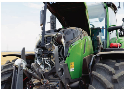
Sous le capot du «728 Vario» ronronne un moteur Agco Power de 7,5 litres équipé d'un ventilateur hydraulique.
