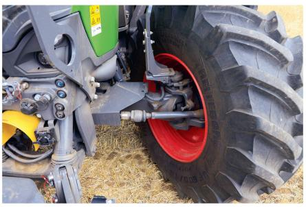
L'angle de braquage est de 52 degrés. Comme les roues avant sont «tirées» dans les virages grâce à la transmission «VarioDrive», le rayon de braquage se limite à 10 mètres.
