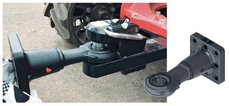
Les anneaux pivotants: la chape et l'anneau présentent un même diamètre. Cela réduit le jeu entre les deux pièces, et aussi les petits à-coups pendant les déplacements.
