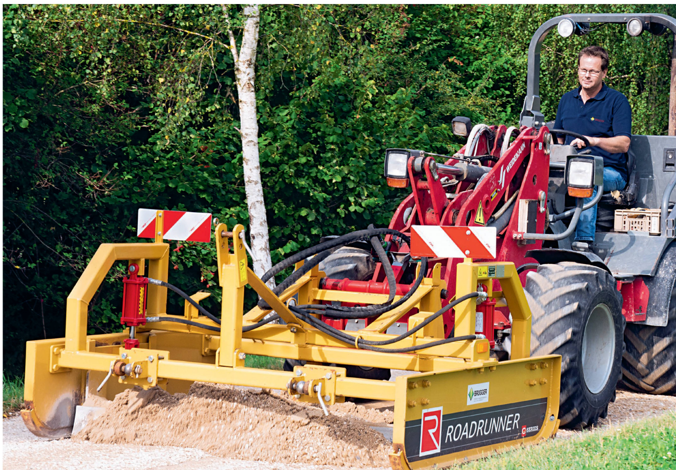
La lame niveleuse «Roadrunner» assure un entretien simple mais efficace des routes en revêtement naturel. Photos: Roman Engeler
