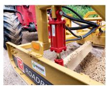
Deux vérins hydrauliques permettent de régler la profondeur de travail de chaque côté.
