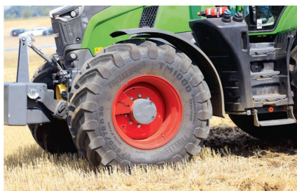
Le système de télégonflage «VarioGrip» se commande depuis la cabine.
