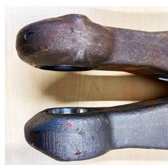
Comparaison entre des anneaux DIN 11026 (en bas) et DIN 74053 (en haut).
