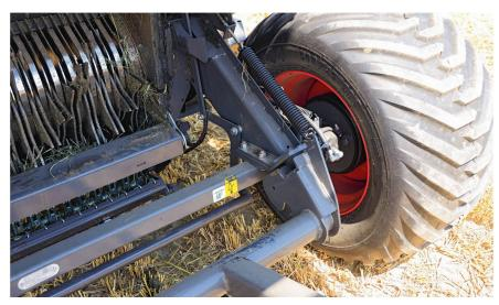
Sur le châssis innovant, on peut monter des roues de grandes dimensions pour une meilleure protection des sols.
