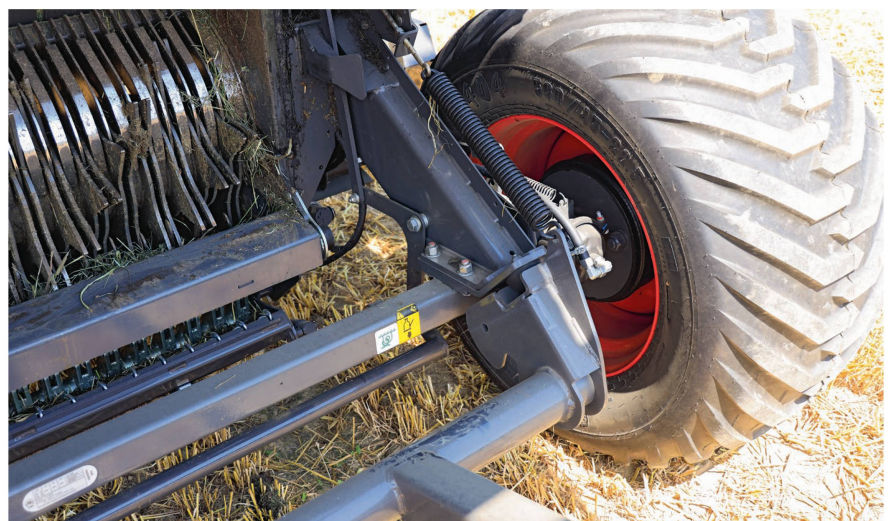
Sur le châssis innovant, on peut monter des roues de grandes dimensions pour une meilleure protection des sols.
