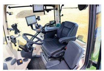
Un siège Isringhausen de grand confort est intégré dans la cabine avec concept de commande «FendtOne».
