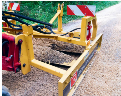
Deux lames légèrement inclinées nivellent la matière décompactée sur toute la largeur de travail.
