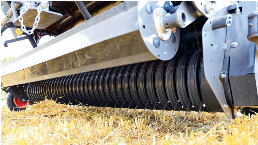
Le pick-up large de 2,35 m (optionnel) possède quatre rangées de dents commandées.
