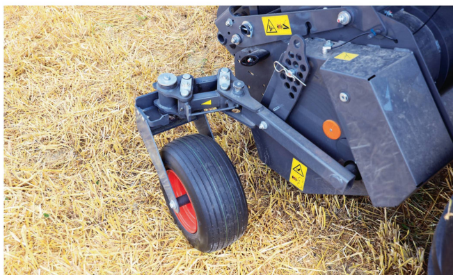
Les roues de jauge pendulaires peuvent désormais être repliées vers l'intérieur pour le transport.
