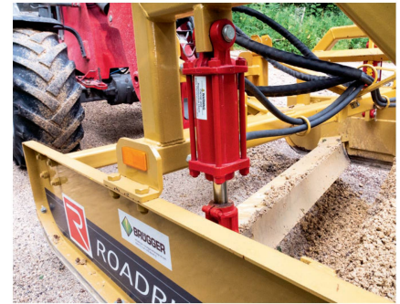
Deux vérins hydrauliques permettent de régler la profondeur de travail de chaque côté.
