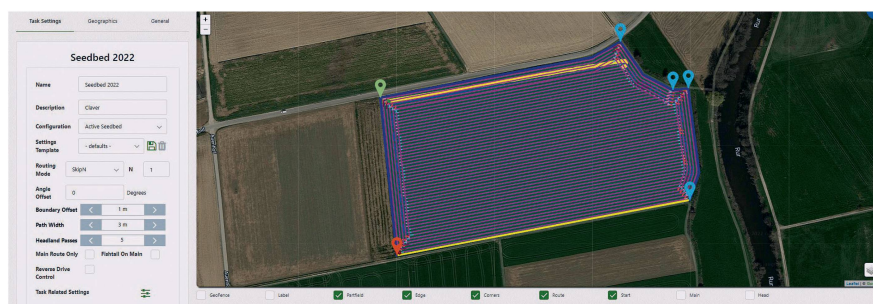
Le portail de planification permet par exemple de gérer les parcelles, les tâches du robot ainsi que le parc de machines avec tous les paramètres des outils attelés.
