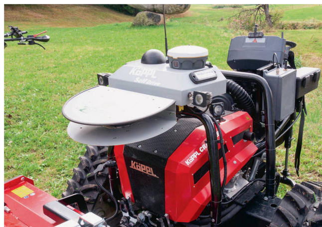
L'unité de pilotage est installée avec des antennes d'émission radio et de réception GPS-RTK, ainsi qu'un scanner à laser (protégé).
