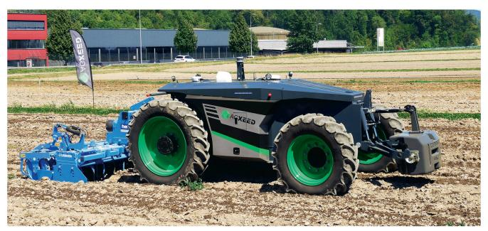
Associé à une herse rotative de 3 mètres de large, le modèle «AgBot 2.055W4» à quatre roues du fabricant hollandais AgXeed ménage le sol. Il pèse à peine plus de 3 tonnes. Photos: Heinz Röthlisberger
