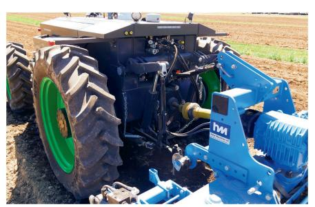
La pompe hydraulique offre un débit de 85 l/min à une pression de 210 bars. Trois distributeurs proportionnels à double effet sont disponibles.
