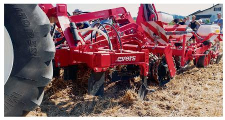
Derrière le décompacteur, des éléments développés spécialement assurent la formation de la butte. On peut procéder si nécessaire à l'enfouissement de fumure ou de fertilisants.
