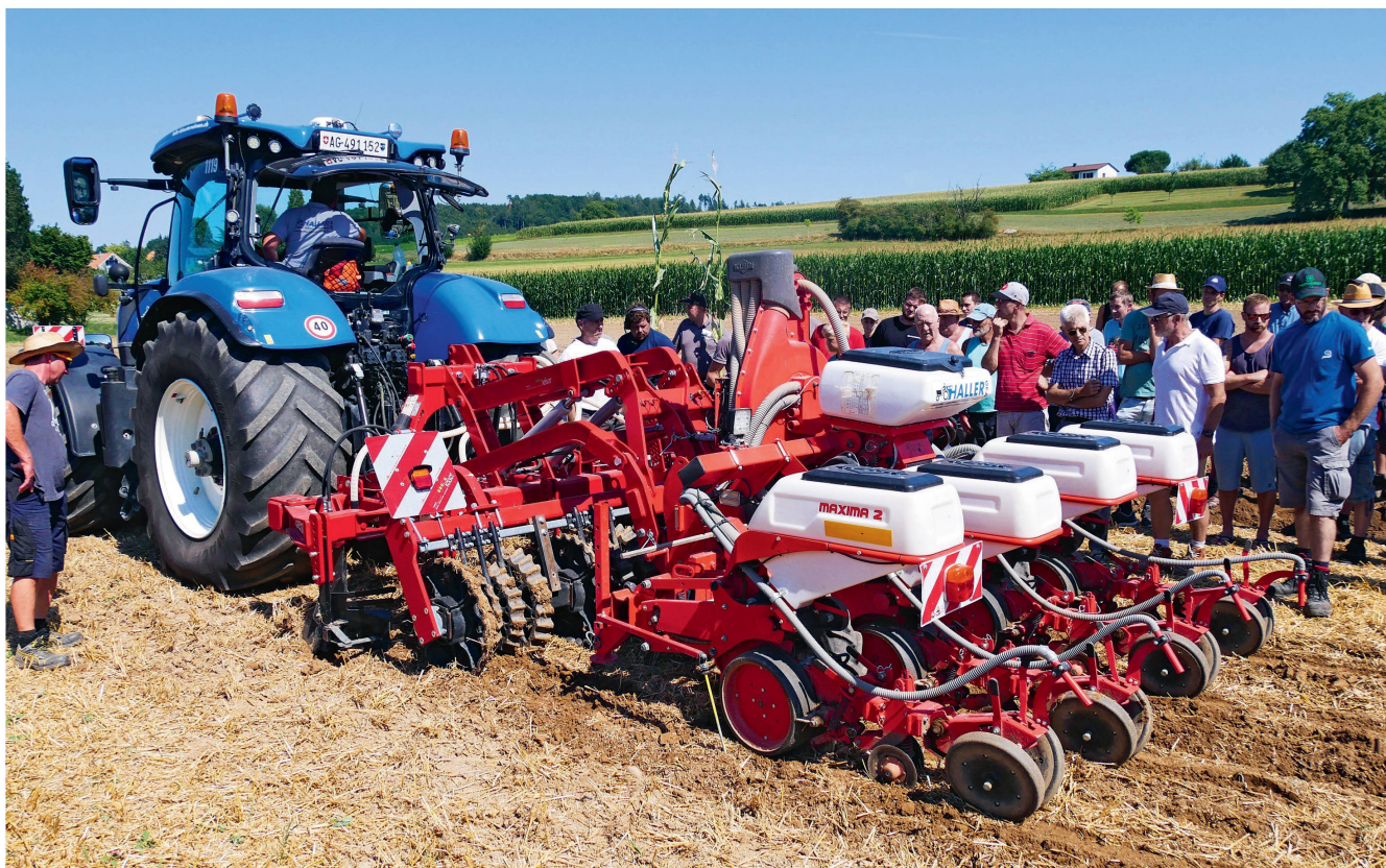
L'outil combiné pour semis sur buttes avec semoir monograine lors de sa présentation en août, sur une parcelle de chaumes. Il permet de constituer les buttes et de semer en un seul passage. Photos: Heinz Röthlisberger
