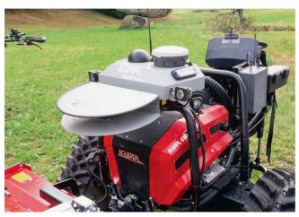
L'unité de pilotage est installée avec des antennes d'émission radio et de réception GPS-RTK, ainsi qu'un scanner à laser (protégé).
