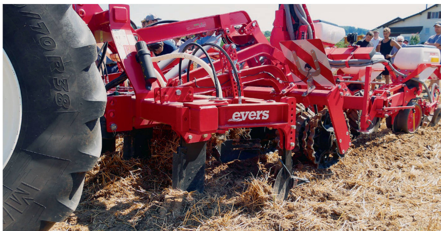
Derrière le décompacteur, des éléments développés spécialement assurent la formation de la butte. On peut procéder si nécessaire à l'enfouissement de fumure ou de fertilisants.
