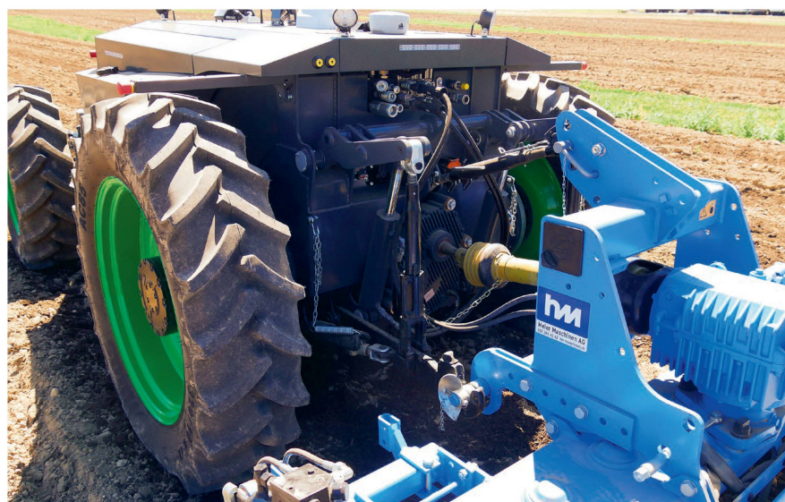
La pompe hydraulique offre un débit de 85 l/min à une pression de 210 bars. Trois distributeurs proportionnels à double effet sont disponibles.
