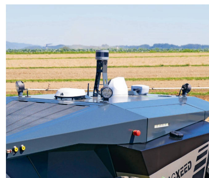
Des récepteurs satellites et une correction RTK assurent le guidage du robot. Un capteur LiDAR observe l'environnement.
