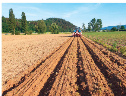
Derrière le décompacteur, des éléments développés spécialement assurent la formation de la butte. On peut procéder si nécessaire à l'enfouissement de fumure ou de fertilisants.
