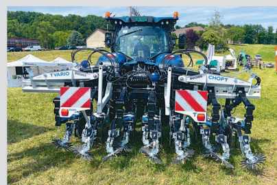
La bineuse Samo «VarioChop» présente de nombreuses possibilités de réglages sans outil.
