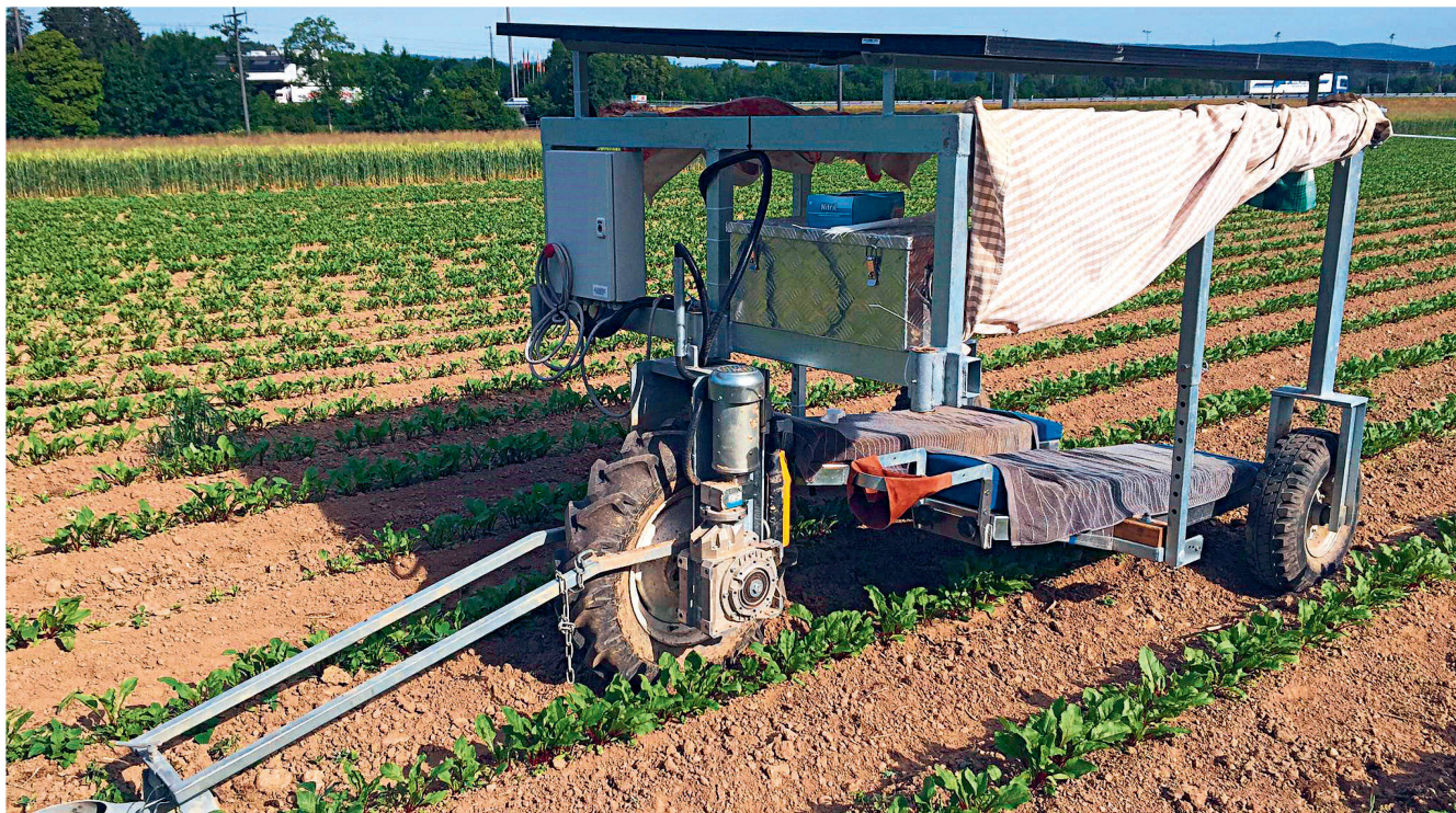
Un concept 100% suisse: le désherbeur à trois roues avec entraînement solaire et deux couchettes. Photo: Daniel Steiner
