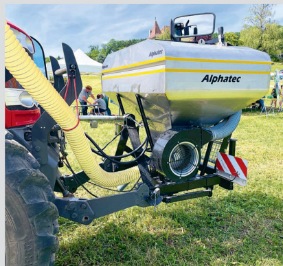
La trémie Krummenacher de 700 litres en inox stocke l'engrais apporté dès le semis ou lors d'un désherbage mécanique.
