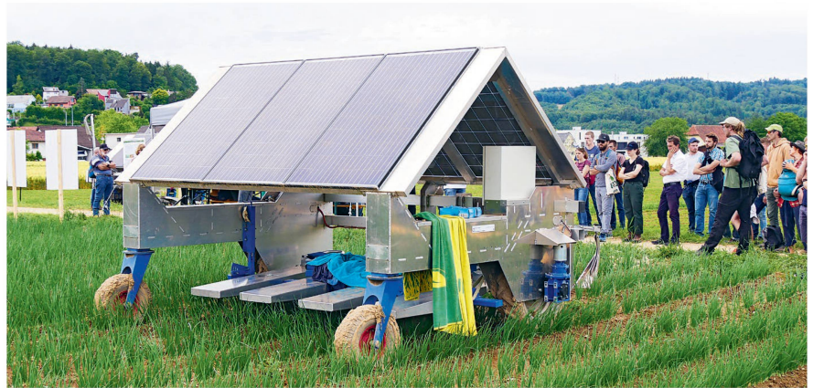
Le désherbeur solaire de l'entreprise néerlandaise De Jong Machines est équipé de quatre couchettes. Photos: Heinz Röthlisberger
