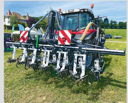
La bineuse «Variofield» de Dickson-Kerner se caractérise notamment par la compacité de son dispositif d'attelage.
