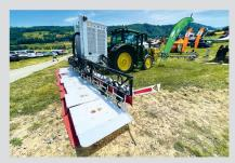
Le défanage électrique est désormais proposé par Agroline sous forme de prestation avec cet outil de crop.zone doté d'une rampe de 9 mètres de largeur.
