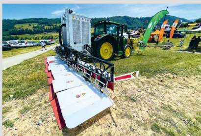
Le défanage électrique est désormais proposé par Agroline sous forme de prestation avec cet outil de crop.zone doté d'une rampe de 9 mètres de largeur.
