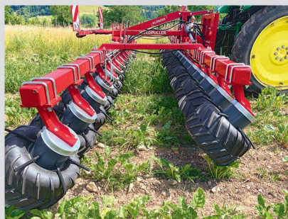
Actuellement en phase de test par Agroscope, l'outil «Weedpuller» a été conçu pour aider les producteurs à désherber mécaniquement leurs parcelles de betteraves sucrières.
