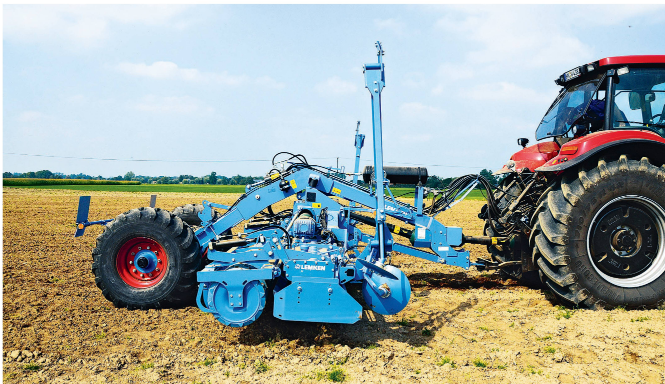
Cet équipement est accroché au tracteur au moyen d'une barre d'attelage, que l'on distingue sous l'arbre de prise de force. Photos: Walterscheid
