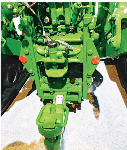
Cette barre d'attelage (en bas) se trouve à l'arrière d'un tracteur John Deere.
