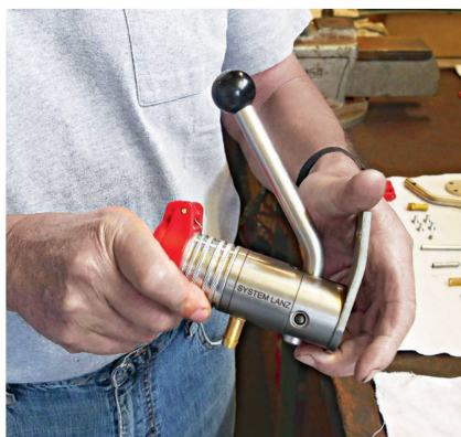
Le décompresseur «Système Lanz» et son levier à double effet.
