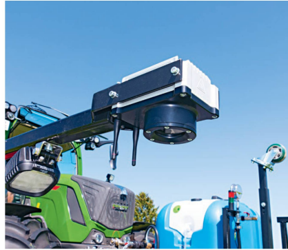
La surface exploitée est scannée avec ces caméras high-tech. Toutes les plantes indésirables sont détectées immédiatement.
