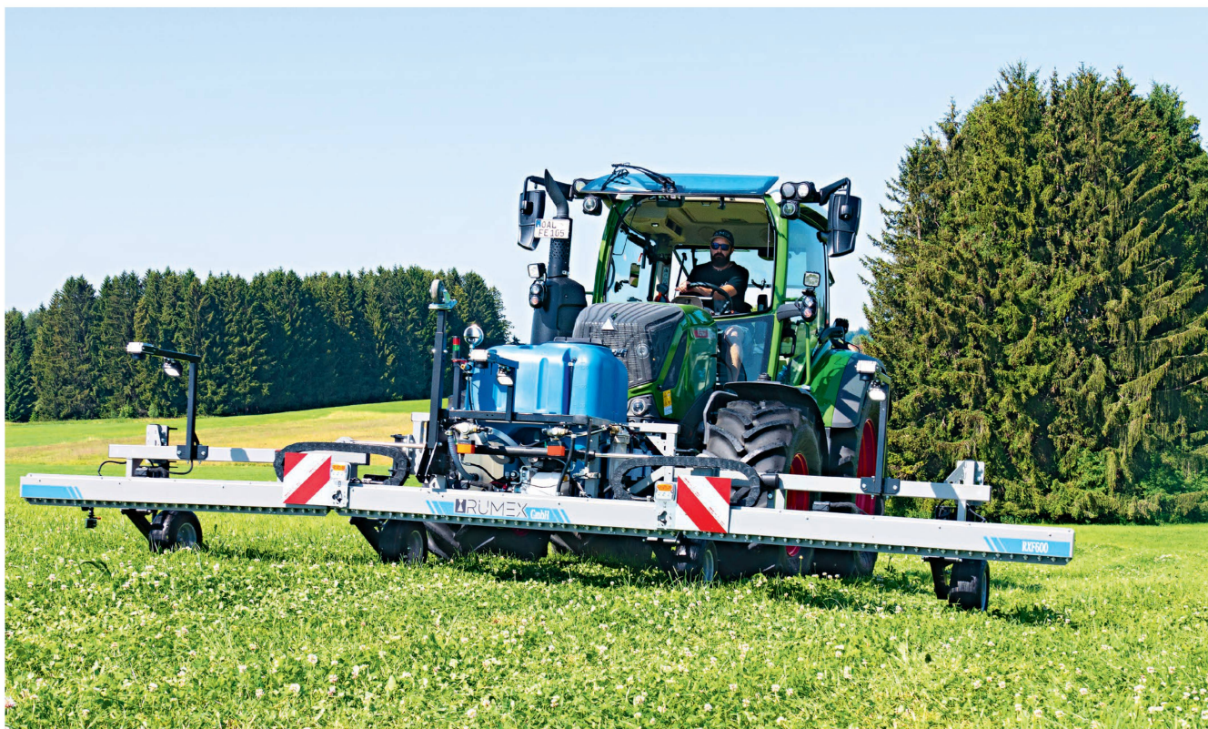
L'outil frontal Rumex «RXF 600» de traitement sélectif des rumex, pèse environ 1 tonne en ordre de marche (cuves pleines). Photos: Roman Engeler
