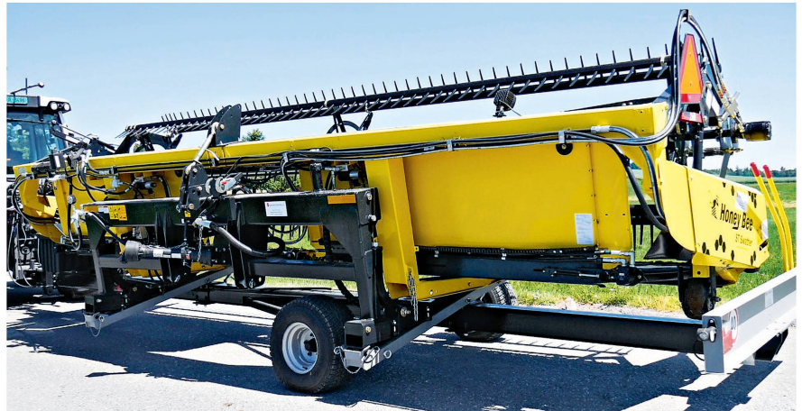
Pour circuler sur la route, la barre de coupe est chargée sur un chariot.
