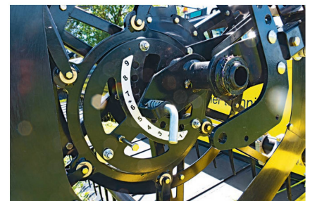
L'angle décisif de préhension des dents du rabatteur peut être ajusté manuellement selon neuf positions.
