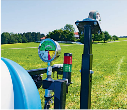
L'indication sur le manomètre et les lumières vertes indiquent que le pulvérisateur est prêt à l'emploi.
