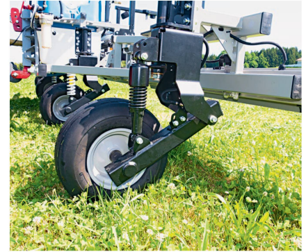
La rampe de pulvérisation est montée de manière flottante et les roues de jauge sont suspendues afin de minimiser les vibrations.
