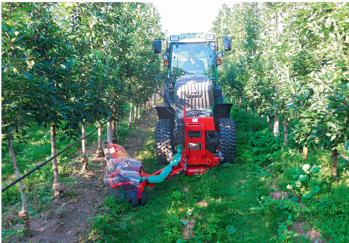
Les machines intervenant sur une seule ligne à la fois sont moins chères à l'achat, mais entraînent des coûts élevés de main-d'œuvre parce que les interventions prennent plus de temps. Photo: Idd
