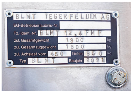
Cette plaque du constructeur atteste la certification CE, selon la directive européenne sur les machines.
