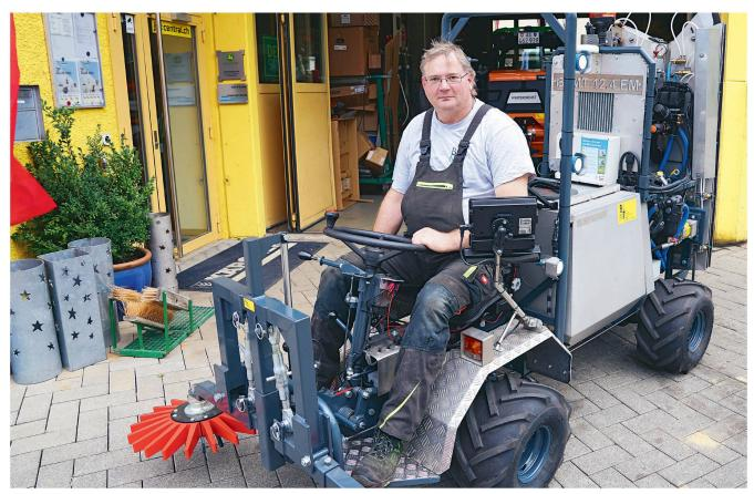
Technicien sur machines agricoles à Tegerfelden (AG), Andreas Baumgartner est au volant de son turbodiffuseur automoteur «BLMT 12.4 FM». Un dispositif de désherbage sur le rang est monté à l'avant du véhicule. Photos: Dominik Senn
