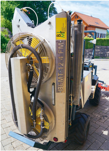
Turbodiffuseur vertical à flux transversal Mitterer «G2» revu et adapté par Andreas Baumgartner.
