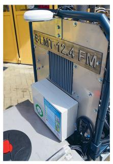
Le récepteur GPS et l'unité de contrôle sont montés au-dessus de la cuve.
