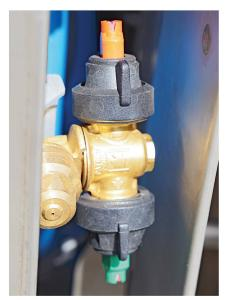
Par rotation de la molette, il est possible de sélectionner l'une des deux buses Arag ou de les arrêter les deux.
