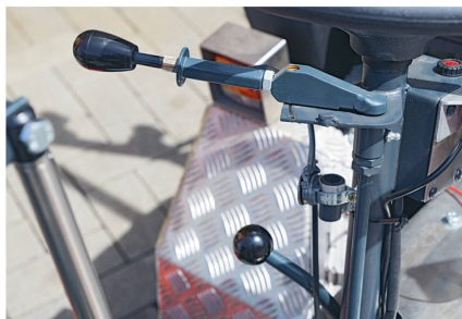
Le levier du haut enclenche l'essieu hydraulique avant, celui du bas commande l'essieu arrière à entraînement mécanique.
