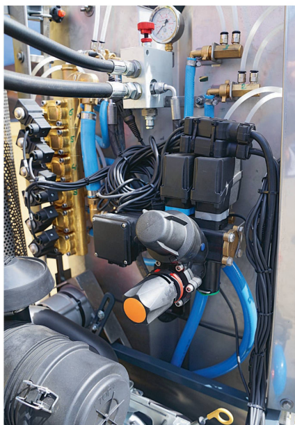
La gestion du flux d'air en haut et en bas se fait en tournant la molette rouge.
