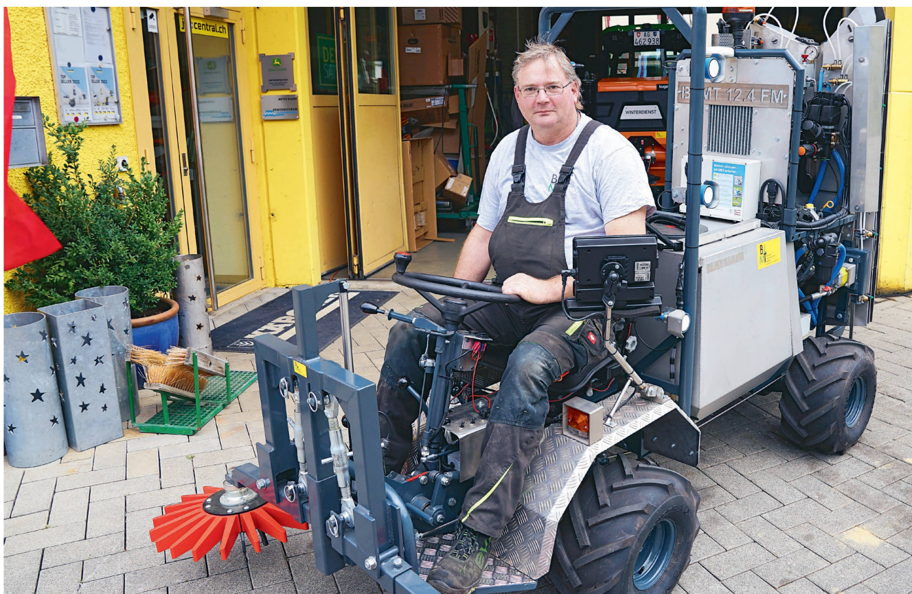
Technicien sur machines agricoles à Tegerfelden (AG), Andreas Baumgartner est au volant de son turbodiffuseur automoteur «BLMT 12.4 FM». Un dispositif de désherbage sur le rang est monté à l'avant du véhicule. Photos: Dominik Senn
