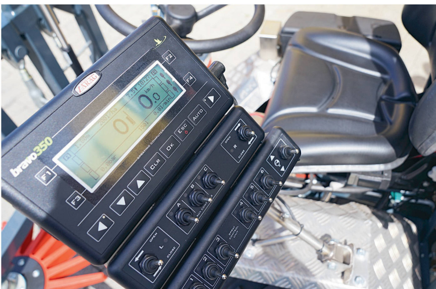
L'ordinateur de bord Arag «Bravo350» gère deux fois trois sections. Il est programmé par Andreas Baumgartner en fonction des vignobles et des souhaits des clients pour une application précise de la bouillie.
