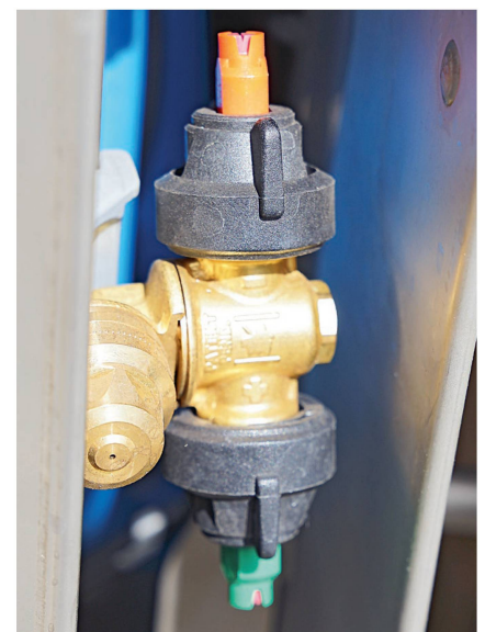
Par rotation de la molette, il est possible de sélectionner l'une des deux buses Arag ou de les arrêter les deux.
