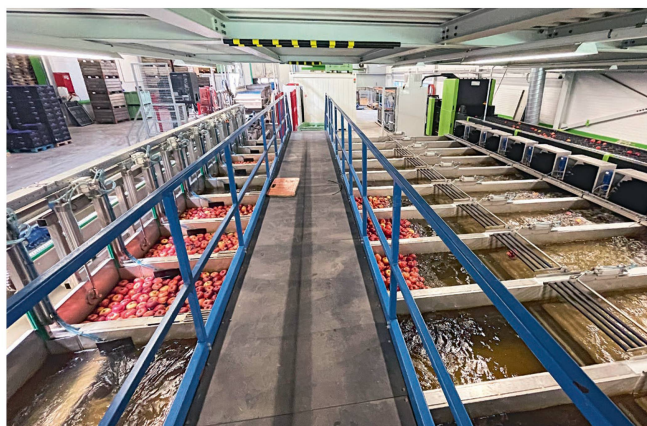
Les fruits déposés dans des « mains » (à droite) tombent par gravité dans l'une des seize zones immergées de mise en lot, selon leur calibre et leur qualité.
