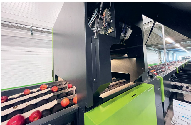
Dans la chambre noire, des caméras haute définition analysent l'aspect extérieur du fruit et identifient ses éventuels défauts et irrégularités géométriques.
