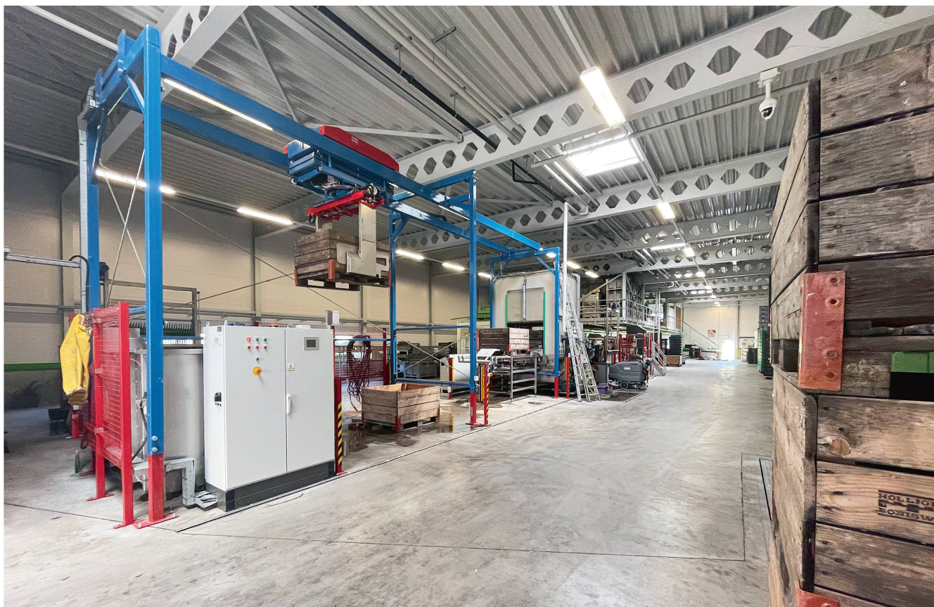
La calibreuse-trieuse «Greefa CombiSort» avec remise en palox à l'eau assure chaque année le tri de 2000 tonnes de pommes et poires sur l'exploitation arboricole Moret Fruits SA. Photos: Matthieu Schubnel
