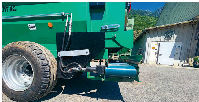
Avec son tapis transversal de 25 cm de large alimenté par les hérissons horizontaux, l'appareil assure un épandage régulier et localisé sur le rang.
