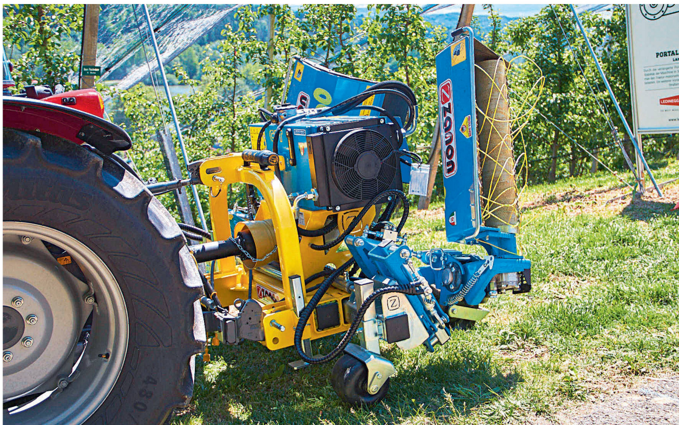
La faucheuse à fils est un outil parmi d'autres pour contrôler les adventices sans herbicides. Photo: Idd
