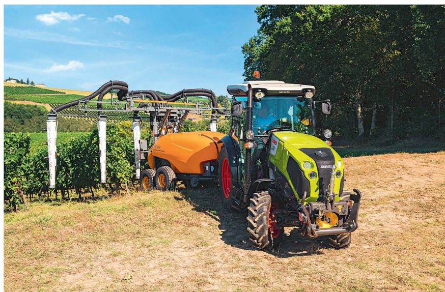
Les tracteurs à voie étroite sont des engins de petite taille, mais costauds, d'une puissance allant de 37 à 79 kW (50 à 108 chevaux). Photo: Claas
