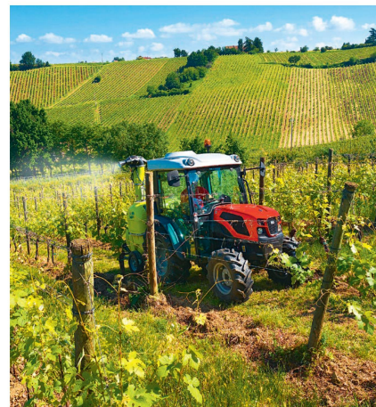
En incluant la cabine, le poids à vide varie entre 2100 et 3100 kilos. Photo: Same
