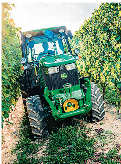
Les tracteurs à voie étroite atteignent plus tôt la limite de basculement. Photo: JD
