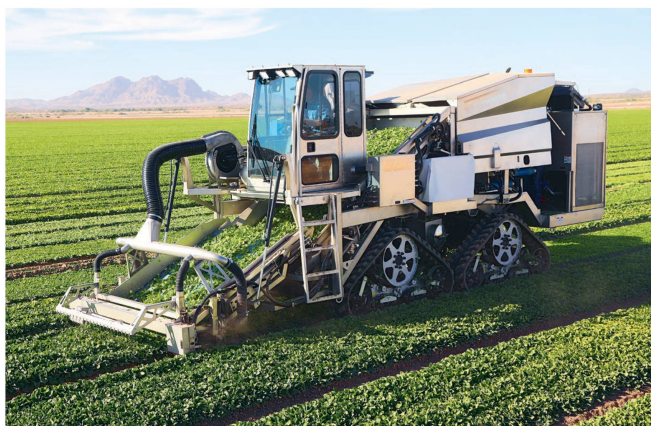
Pour répondre aux exigences des clients, cette récolteuse d'épinards automotrice est constituée d'acier inoxydable.
