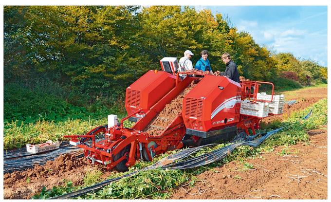
Cette récolteuse de patates douces semi-autonome est un prototype. La décision de la produire ou non en série sera prise à l'automne 2022. Photo: schmiede.one
