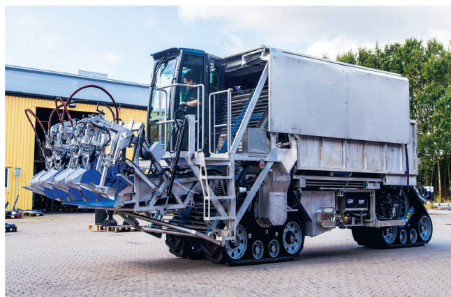
Cette récolteuse de salades est construite en acier inoxydable.
