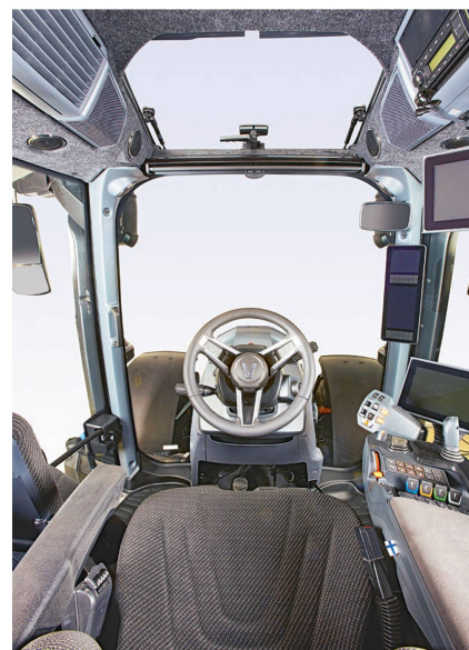
La cabine est celle de la série «T». Elle offre un grand confort avec sa suspension pneumatique et son accoudoir «SmartTouch».
