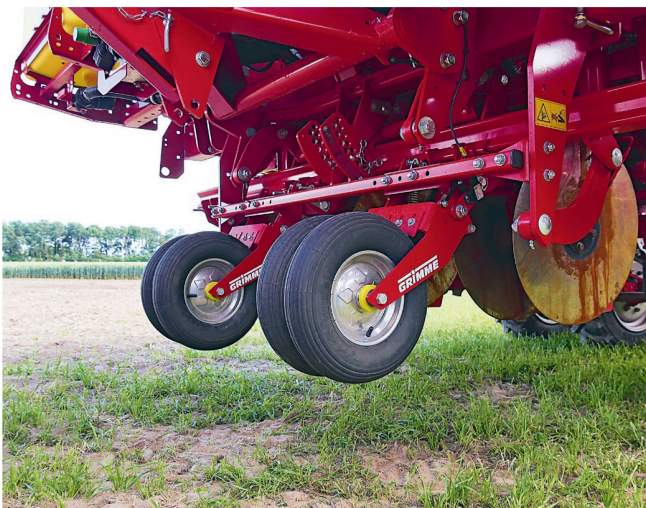
Deux roues de jauge doubles et deux capteurs à ultrasons assurent un guidage en profondeur précis.
