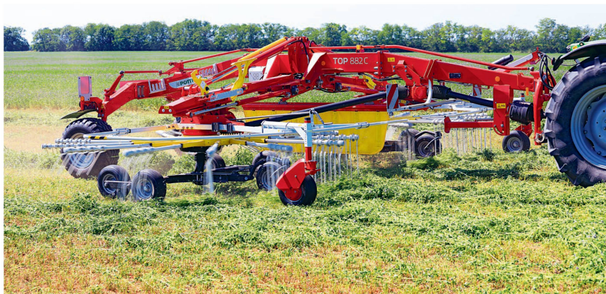
L'andaineur à dépose centrale «Top 882 C» forme des andains de 2,60 mètres de large.
