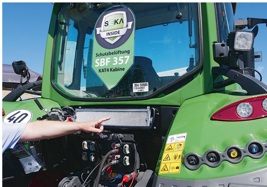
Peu encombrant, le «SBF 357» peut être intégré dans la cabine des modèles des trois gammes de Fendt. Le capot du filtre montré ici a été enlevé. Photo: Heinz Röthlisberger
