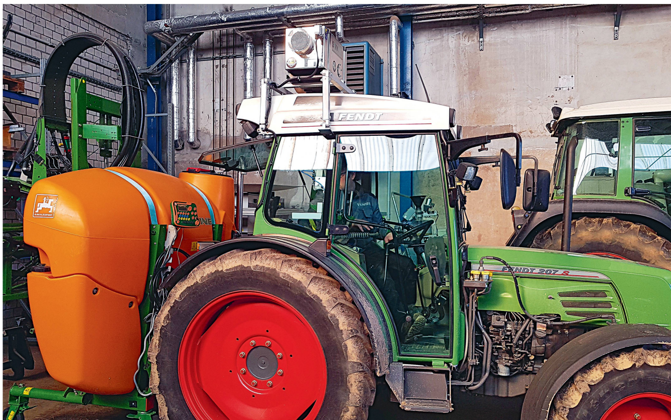
Le ventilateur «SBT 50» se monte à l'extérieur du tracteur. Sur ce Fendt «207 S» par exemple, il est installé sur le toit de la cabine. Photos: Seka
