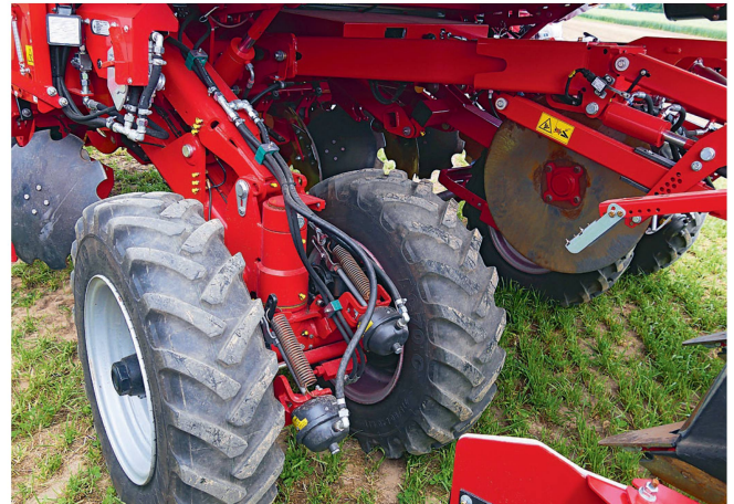
Des essieux télescopiques optionnels permettent de ramener la largeur de 3,30 à moins de 3 mètres pour le transport sur route.
