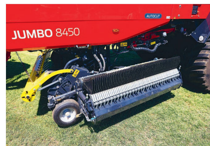
La «Jumbo 8000», avec ses 65 couteaux, hache le fourrage presque 30% plus court que la «Jumbo 7000».
