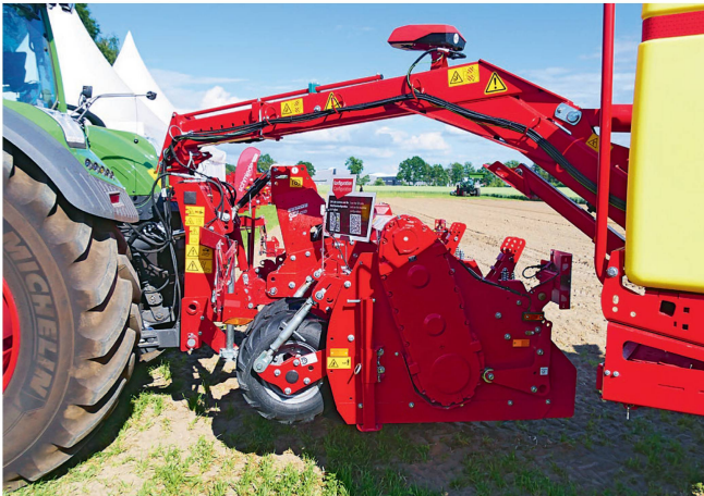
Le dispositif de levage séparé autorise l'attelage de tous les outils courants de préparation du sol. Photos: Heinz Röthlisberger
