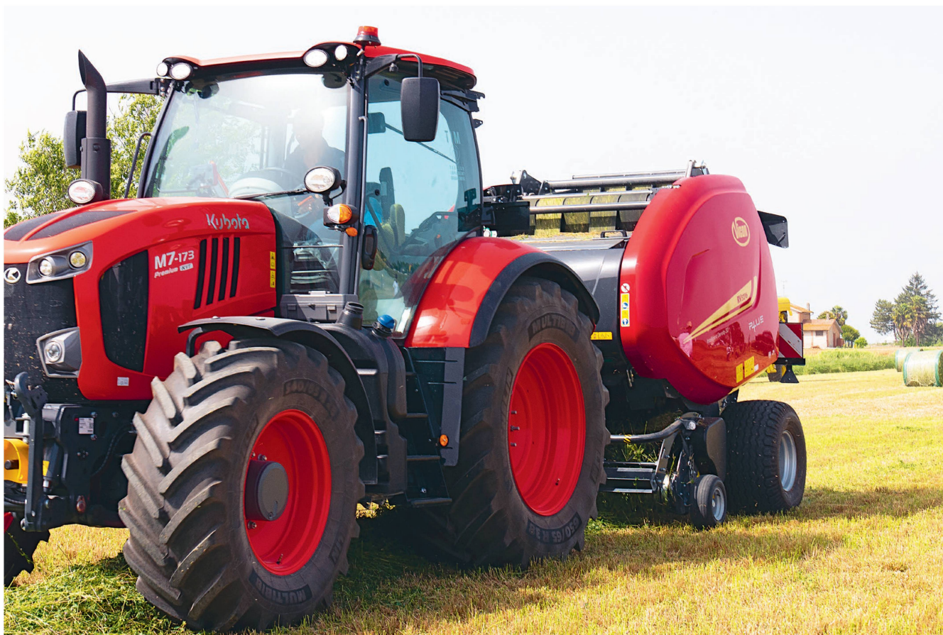
«La machine commande le tracteur» ou «Tractor Implement Management»: Kverneland a adapté pour la première fois ce système sur ses presses. Photos: Roman Engeler
