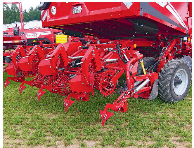
Une combinaison de plaques et de diabolos ajournés produit des buttes aux flancs lisses et stables et aux crêtes aérées.
