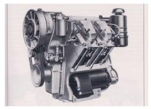
Le moteur 4-cylindres «D 41» de 40 chevaux est le plus grand que Warchalowski a produit pour ses tracteurs. Il possède la configuration en «V» typique de la marque, et un refroidissement à air.
