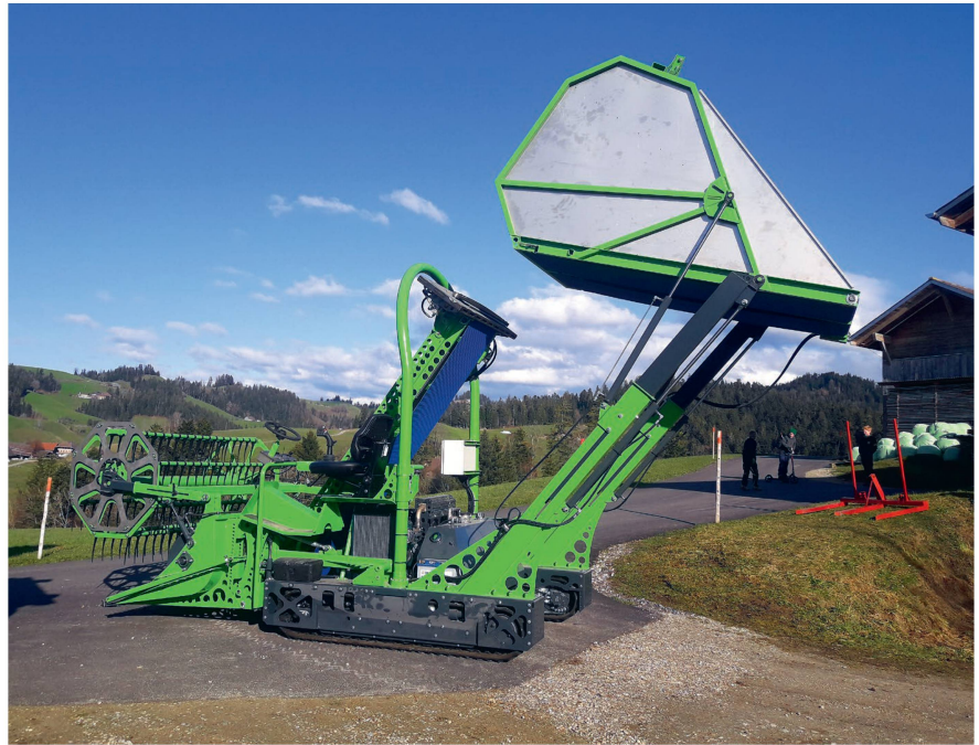
La récolteuse à plantes aromatiques est montée sur un train roulant à chenilles. On distingue les rabatteurs, le convoyeur et la trémie. Elle va tourner cette saison pour la première fois.
