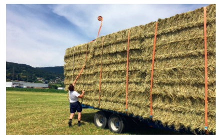
Le transport de grandes balles doit être sécurisé correctement, avec suffisamment de sangles d'arrimage.
