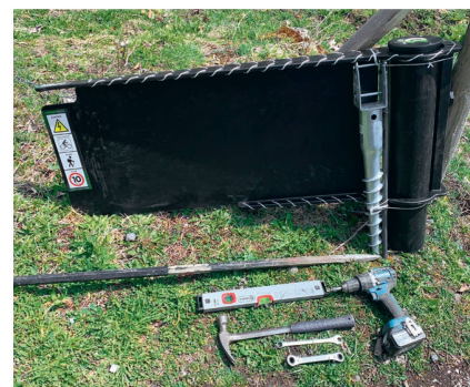
Le matériel et l'outillage nécessaires au montage du portail, avec la vis d'ancrage.
