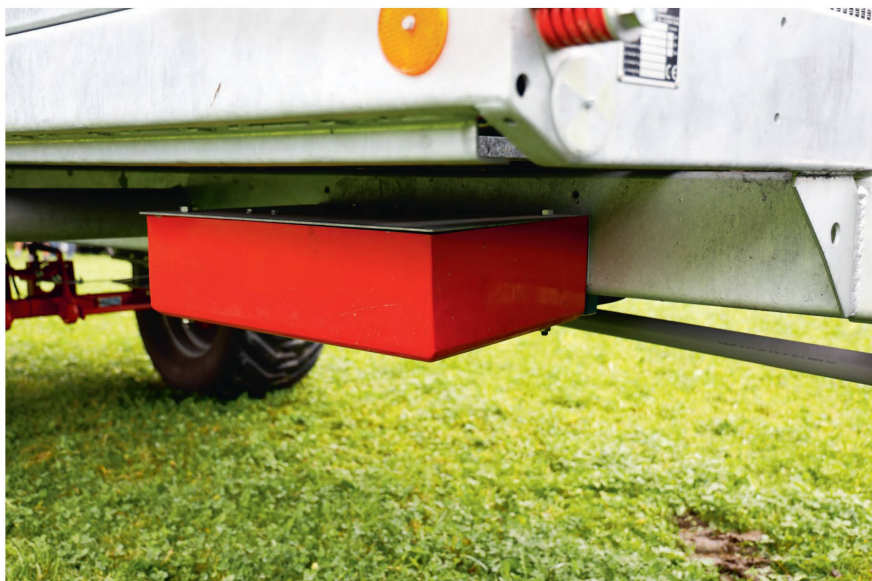
Le boîtier de commande est bien protégé à l'avant droit de la machine.
