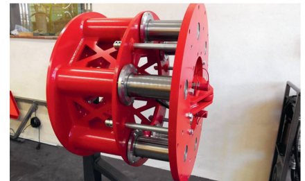
Six arbres de transmission de puissance et autant d'arbres de guidage relient la roue principale à la roue extérieure et assurent un déplacement sans à-coup.
