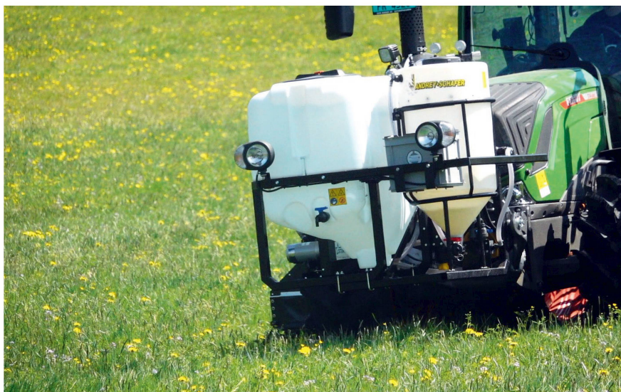
Les 600 litres d'eau claire du réservoir frontal suffisent pour une journée de traitement.
