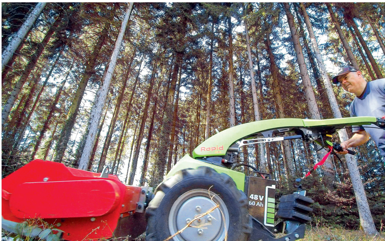
Le Rapid «URI» se déplace en produisant peu d'émissions avec un moteur de 1,2 kW et un moteur pour la prise de force. Photos: Roman Engeler
