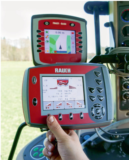
Le boîtier «Quantron-A» commande l'automatisme de dosage «EMC», assure la coupure des tronçons et régule le débit massique selon la vitesse d'avancement.
