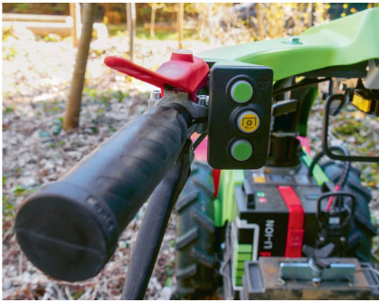
Le bouton pour l'engagement de la prise de force se trouve sur le montant gauche du guidon.
