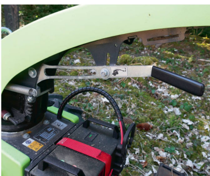
La hauteur et l'inclinaison du guidon sont rapidement ajustables via deux leviers.
