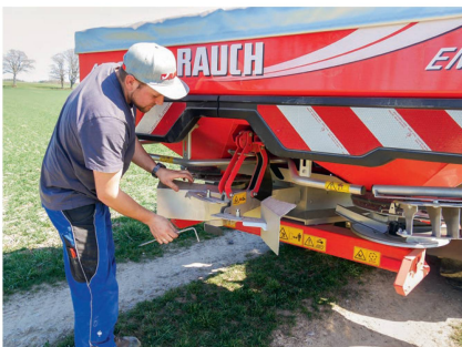
Le limiteur d'épandage «GSE» (à gauche) est conçu pour un épandage précis jusqu'en limite de champ. Quant au «Telimat», il permet un épandage en bordure précis dès le premier passage.
