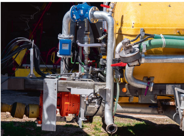
Le lisier aspiré par la pompe orange traverse le dispositif by-pass où il est enrichi d'additifs provenant de la citerne. On distingue la soupape anti-retour (en bleu) au sommet du col-de-cygne.
