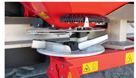
Les servomoteurs «SpeedServo» assurent une réaction rapide des vannes de dosage et font varier le point de chute pour la gestion par section.
