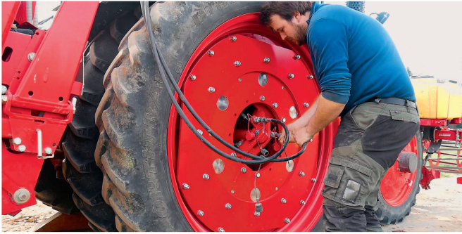
Deux tuyaux sont connectés au système hydraulique embarqué du tracteur pour le processus de changement de largeur de voie.
