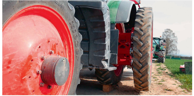
La roue principale est posée sur une cale en bois durant les opérations de déploiement et de rétraction de la roue jumelée.
