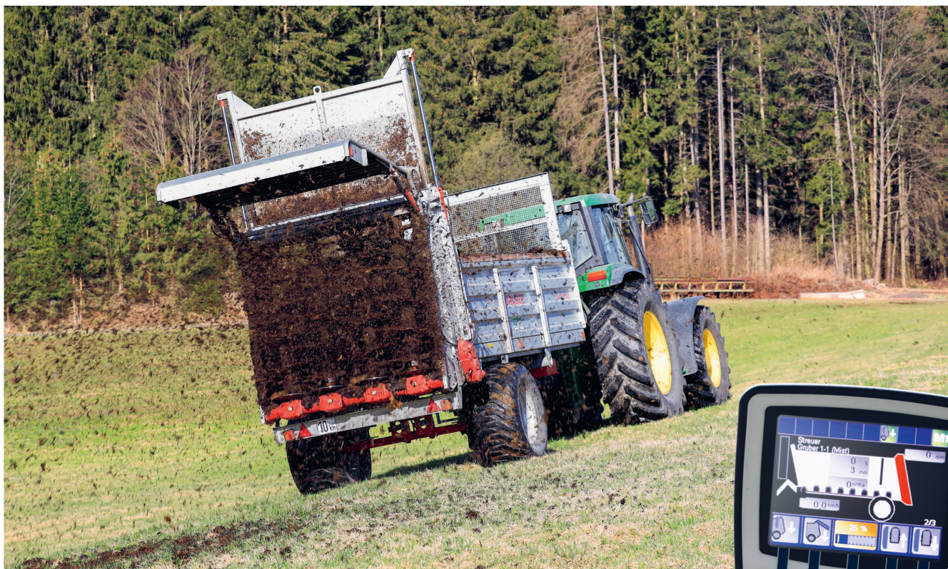
La commande électrohydraulique permet un épandage fin et régulier du fumier avec l'épandeur «SM 850» de Gruber. Photos: Johannes Paar
