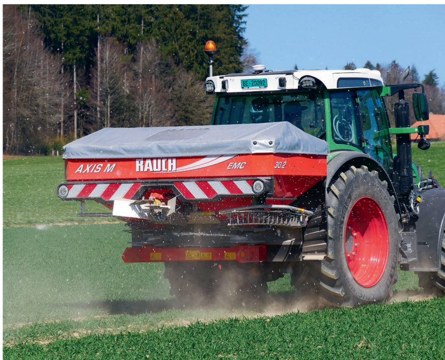
L'épandeur d'engrais Rauch «Axis M30.2 EMC» muni de son octuple dispositif de gestion par section «VariSpread Pro» en pleine activité dans un champ de blé. Photos: Heinz Röthlisberger
