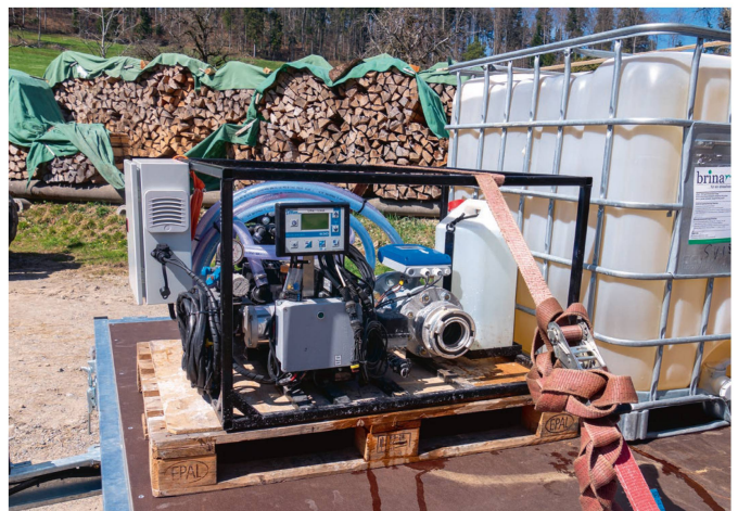
Une installation plus simple, mobile, montée sur une remorque de voiture. Elle peut être alimentée à partir du réseau ou au moyen d'une génératrice. Les additifs sont contenus dans une cuve.
