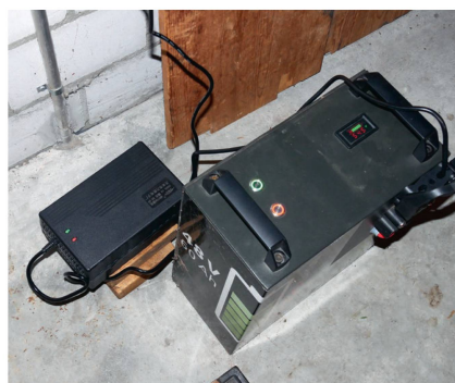
Le temps de recharge est d'environ sept heures avec le chargeur standard.
