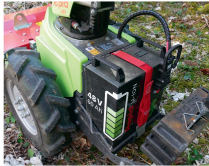
L'énergie est fournie par une batterie d'accumulateurs ion-lithium de 48 volts qui pèsent 22 kilos.
