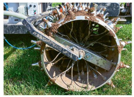
Le liquide est introduit à travers les ouvertures latérales, au moment où les «picots» pénètrent dans le sol.
