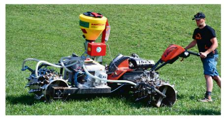
Injecter plutôt que semer. La suspension de spores fongiques sous forme liquide est introduite dans le sol à l'aide de l'Ibex «MMexit».
