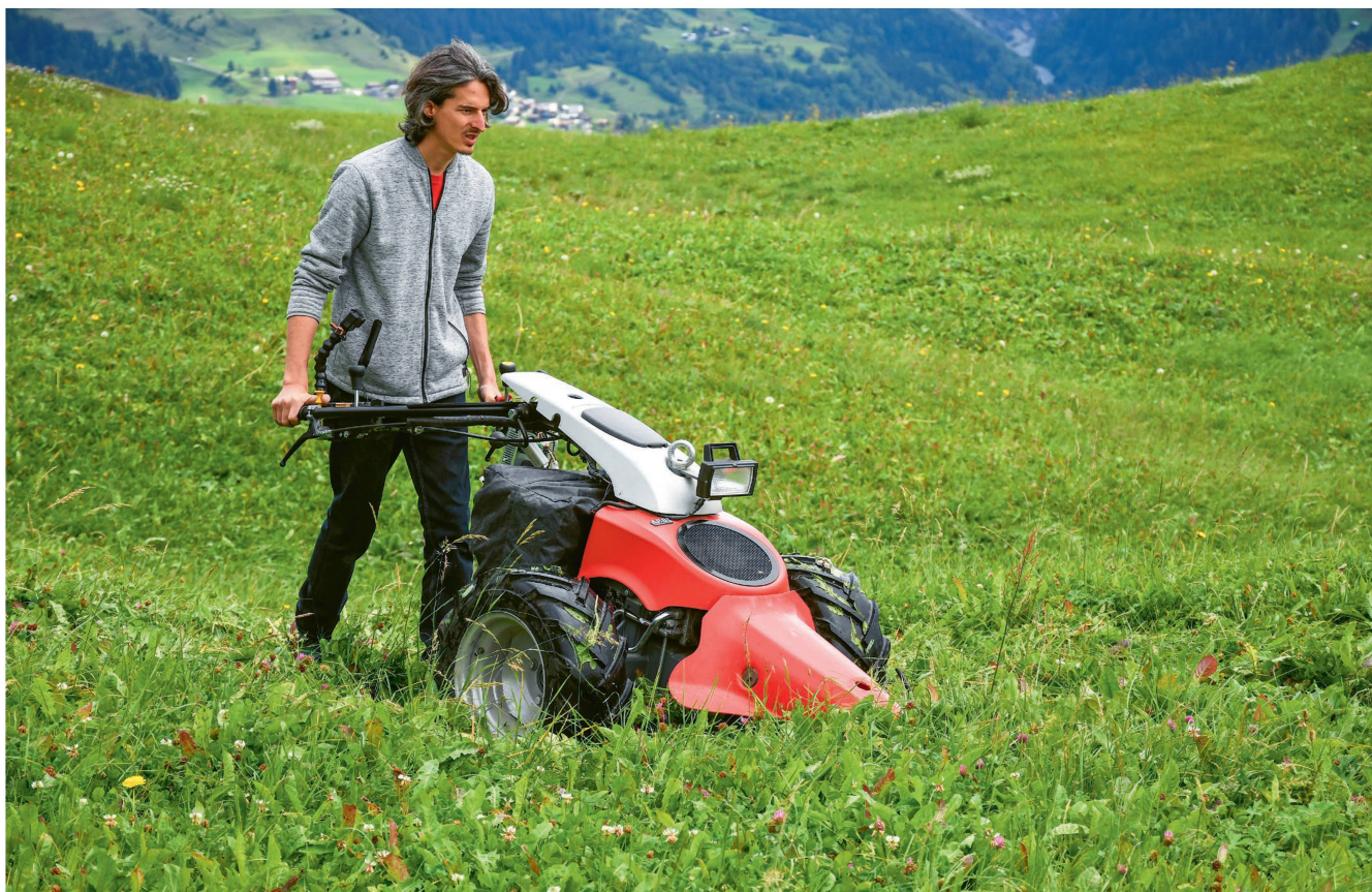
Gian Caduff travaille avec une motofaucheuse convertie en «ePowerUnit». L'entraînement électrique permet une fauche plus détendue, sans gaz d'échappement et avec moins de bruit. Photos: Ruedi Hunger
